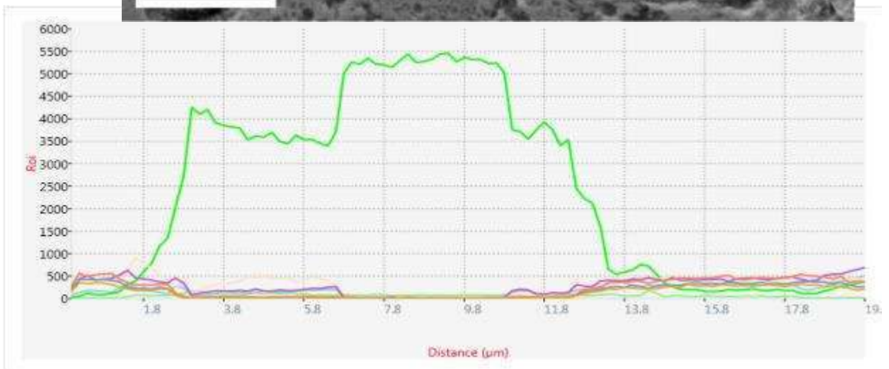
Figura 46 Line scan de la HEA 2 en la zona rica en C y Si.
