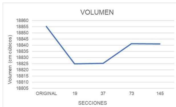
**Fig. 37:** Volumen del álabe reconstruido respecto al número de secciones
