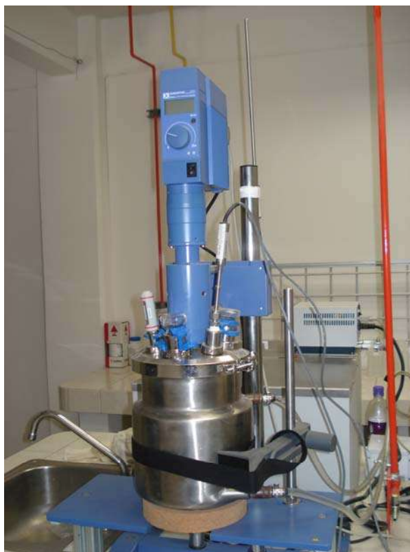
Figura 3.26 Reactor batch marca Eurostar RL-2.10 con varilla agitadora
