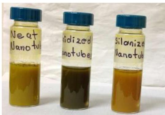
**Figura E1. Soluciones inestables de nanotubos y CdS.**
