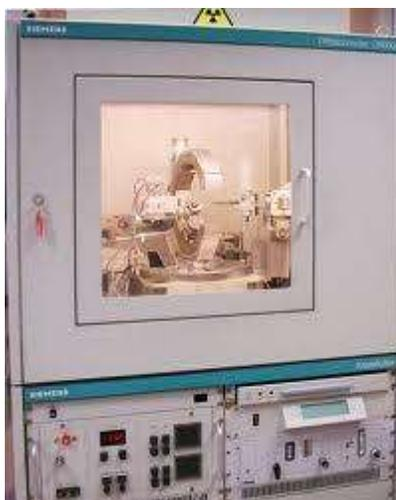
*Figura 8. Difractómetro de rayos X SIEMENS D5000.*
