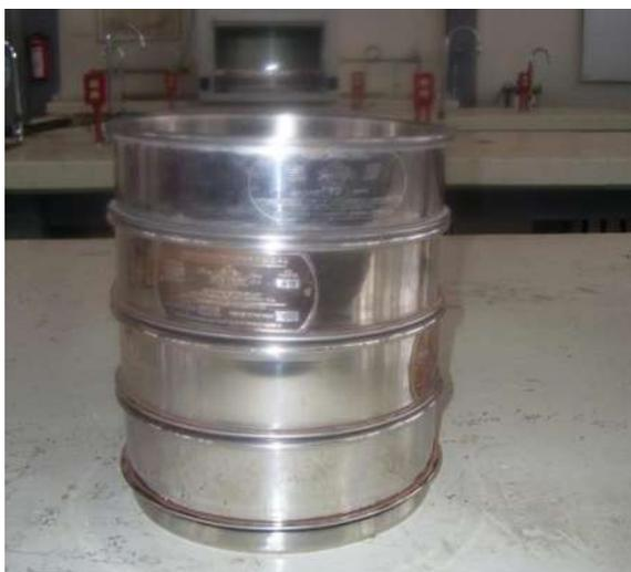
Figura 7. Tamices de separación.
