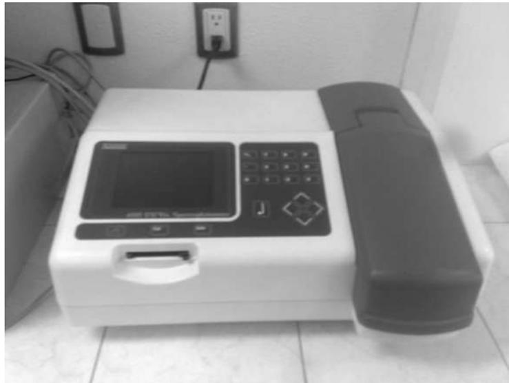
*Figura 11. Espectrofotómetro UV-Vis.*
