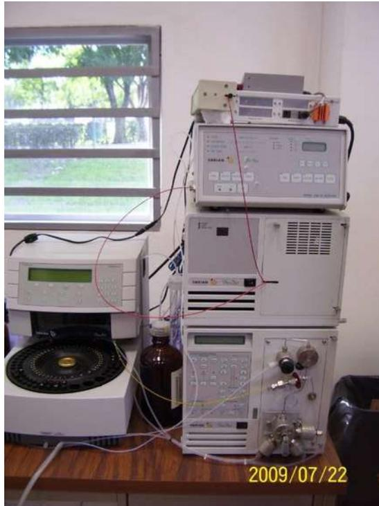
*Figura 10. Cromatógrafo de Líquidos de alta resolución HPLC.*
