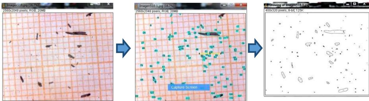
Figura 12. Capturas del software ImageJ utilizado para la medición de las partículas. a) Fibras de biomasa b) Identificación c) mediciones del contorno de las partículas identificadas. Los cuadros tienen una medida estándar de 1 mm.
