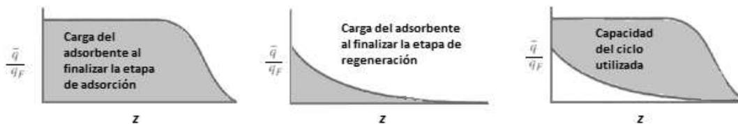
**Figura 2.16** Diferencia de carga para la etapa de regeneración [Seader and Henley 2006].
