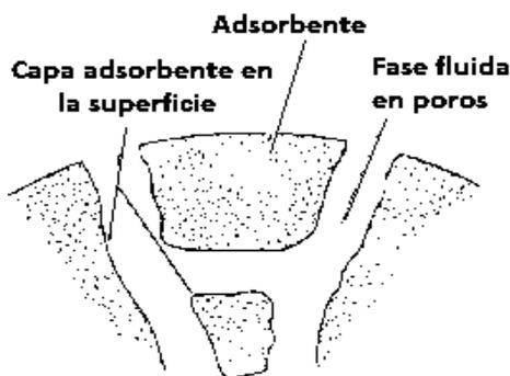
**Figura 2.6** Operación de adsorción con un solvente de partículas sólidas, [Seader and Henley 2006]
