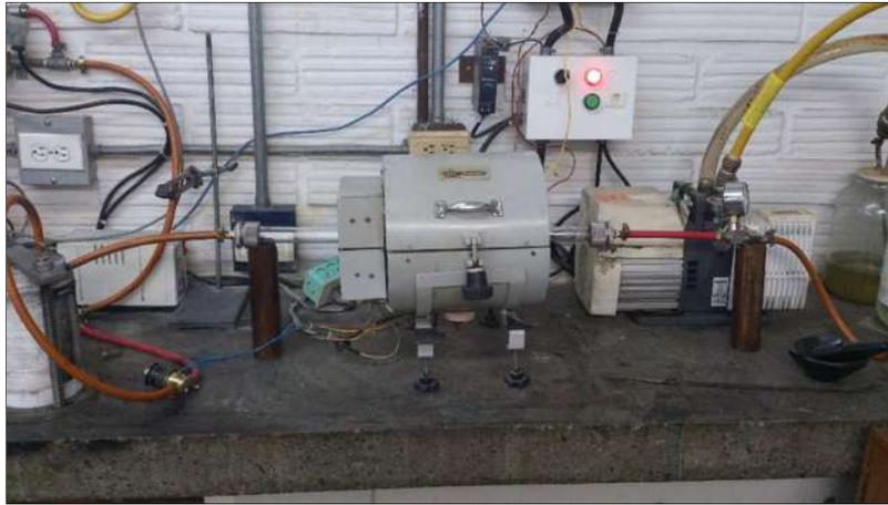
*Figura 3. 2 Equipo de síntesis de nanotubos de carbono por CVD*
