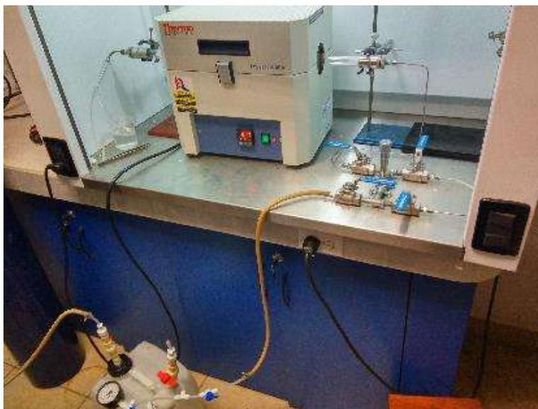
Fig. 7.8. Alimentación de biogás al reactor CVD.
