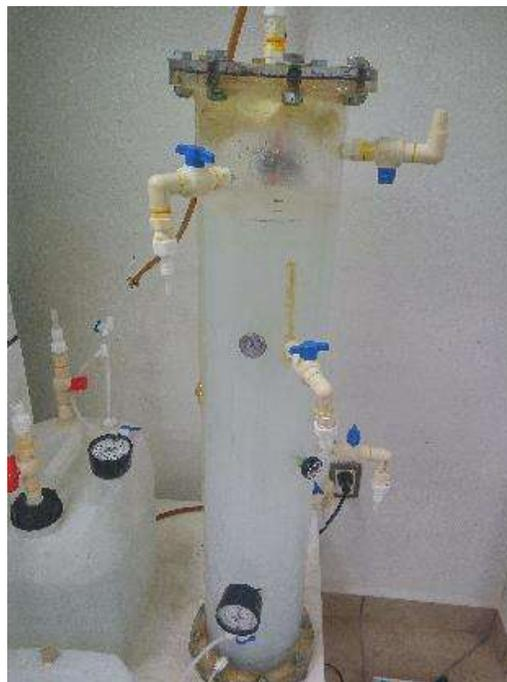
Fig. 7.7. Reactor de burbujeo para la purificación del metano del biogás.
