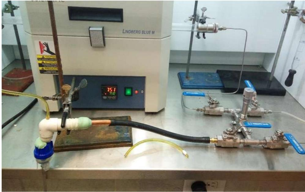
Fig. 7.6. Sistema de alimentación de precursores líquidos hacia el reactor CVD.
