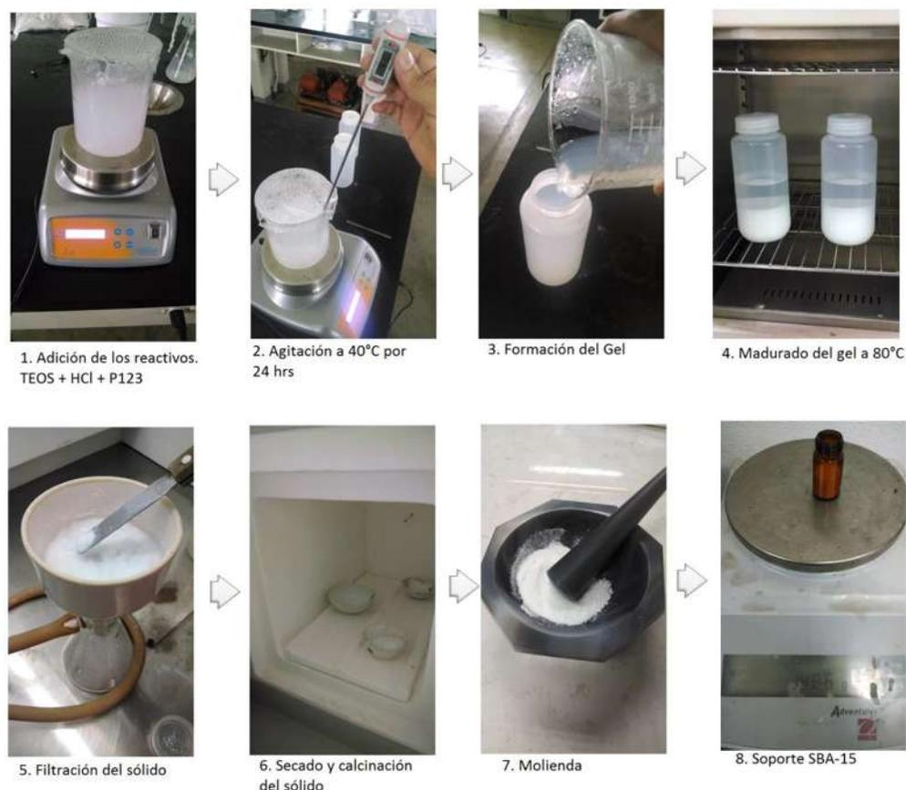
**Fig. 7.1.** Síntesis del soporte SBA-15.
