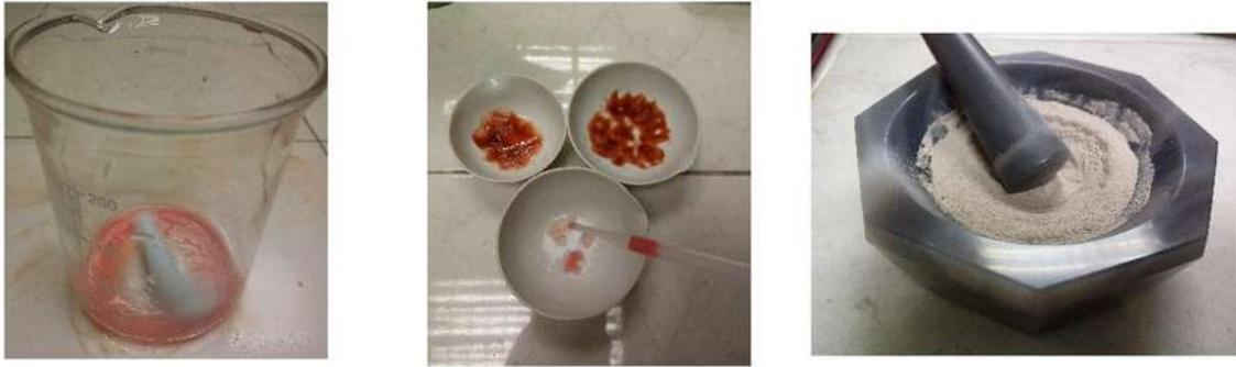
Fig. 7.2. Adición de la fase activa bimetalica por medio del método de impregnación incipiente.
