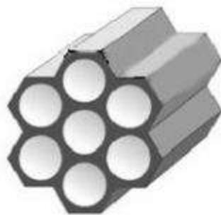
Fig. 5.10 Estructura de la sílice mesoporosa SBA-15.
