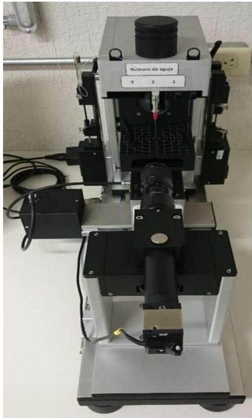
**Figura 7-12.** Dispositivo de ángulo de contacto y análisis de contorno *DataPhysics Instruments*, modelo *OCA 50*.
