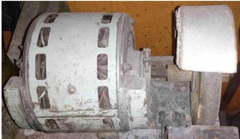
**Figura 7-2.** Esmeriladora eléctrica montada con un disco de esmeril fino.
