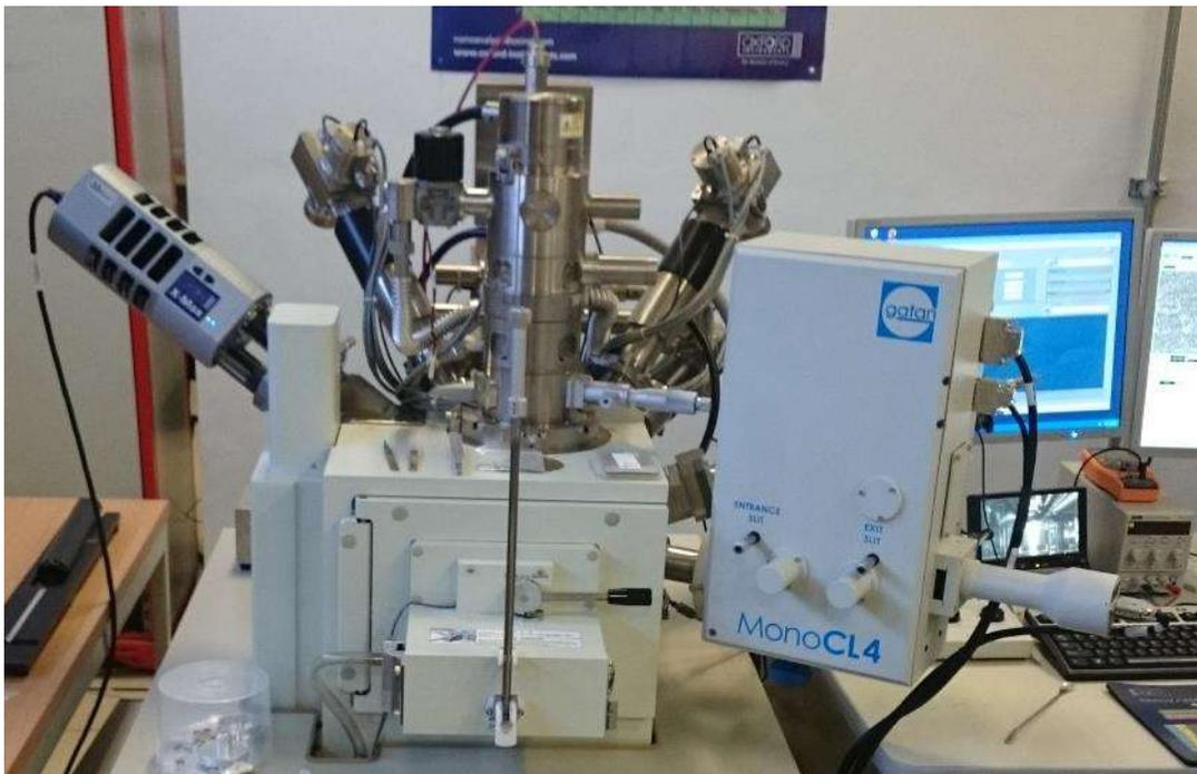
**Figura 7-11.** Microscopio electrónico de barrido y haz de iones enfocados JEOL, modelo *JIB-4500 MultiBeam*.
