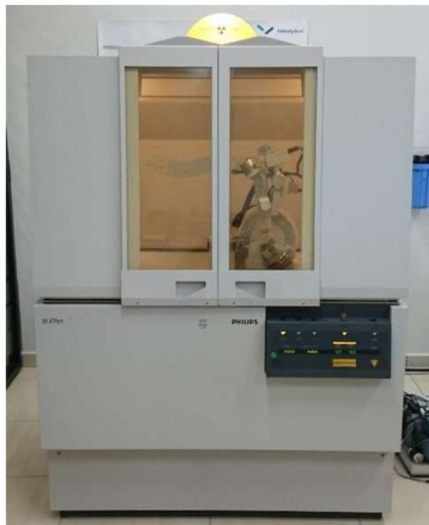
**Figura 7-8.** Difractómetro de rayos X *Philips*, modelo *X'Pert MPD*.
