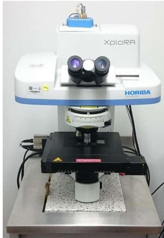
**Figura 7-9.** Espectrómetro Raman *HORIBA*, modelo *XploRA*.
