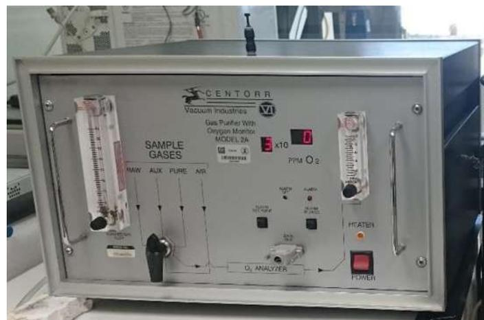
**Figura 7-5.** Purificador de gas inerte y monitor de oxígeno *Centorr/Vacuum Industries*, modelo 2A.
