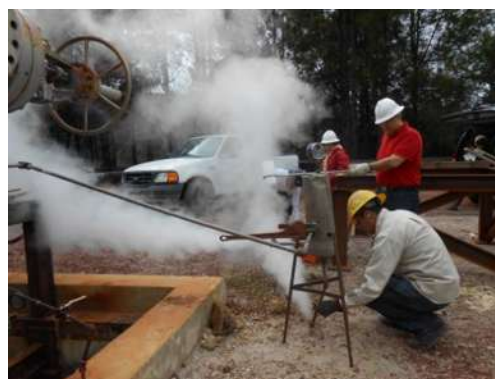
Fotografías M Se conecta el separador portátil y se purga.
