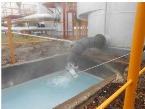
Fotografías A Toma de 3 muestras de agua de 1L y de 2 muestras de 40mL en el vertedor.
