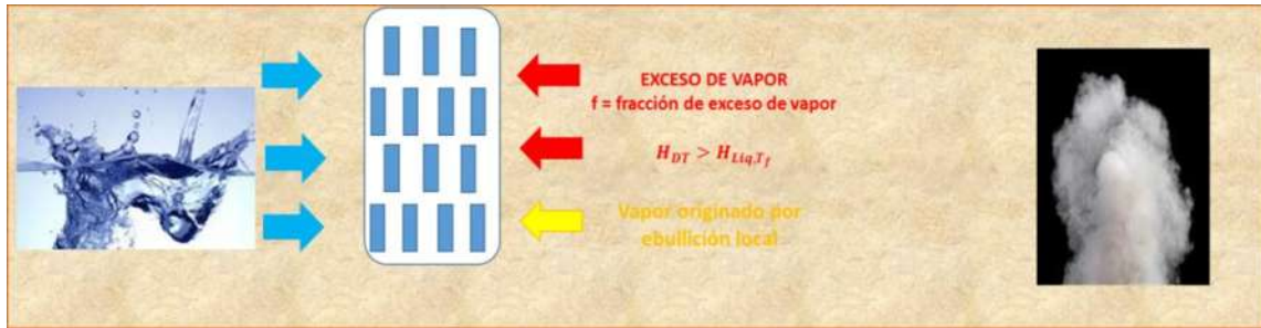
Ilustración 3-18 Exceso de vapor a la alimentación del pozo.
