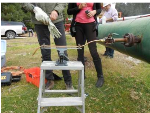
Fotografías G Escalera con tornillo de banco, tubo de cobre de 3/8" y equipo muestreador de gas.
