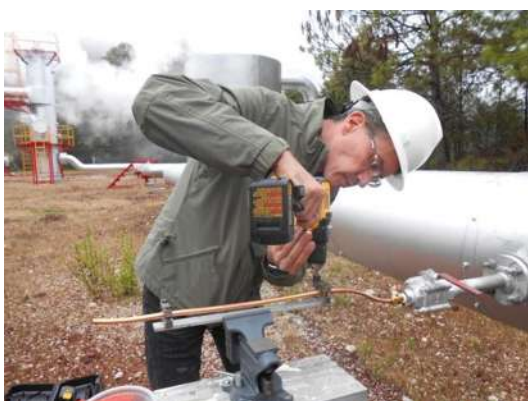
Fotografías K Se cierran las prensas con el taladro para sellar el tubo. Se libera presión antes de desconectar la muestra contenida en el tubo.
