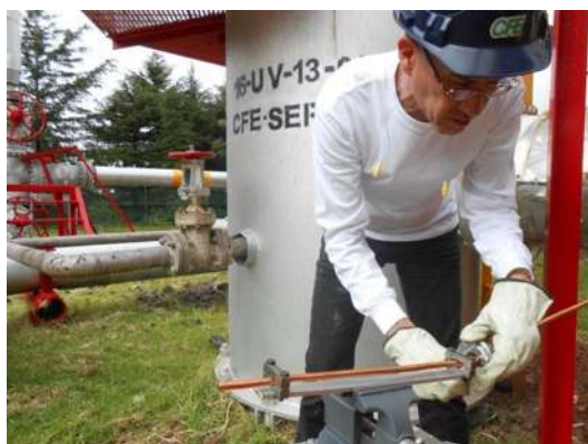
Fotografías L Se corta el tubo de cobre sobrante y se recupera la muestra.
