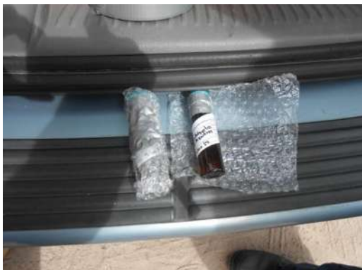
Fotografías D Las muestras de agua de 40mL se sellaron, etiquetaron y se empacaron con plástico burbuja.
