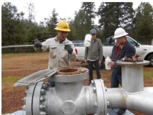
Fotografías C Recolección de muestras del agua de inyección, en el cabezal y en una caja rompedora.
