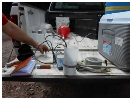
Fotografías B. Medición de temperatura, pH y conductividad eléctrica a las muestras de agua.
