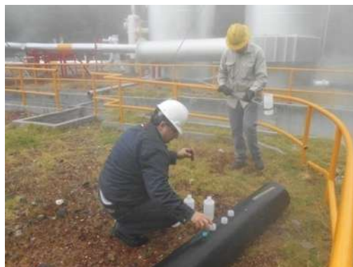
Fotografías A Toma de 3 muestras de agua de 1L y de 2 muestras de 40mL en el vertedor.
