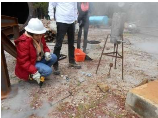
Fotografías N Se conecta el sistema de muestreo, se cierran las prensas y se sellan los tubos y al final se libera la presión antes de cortar el tubo.
