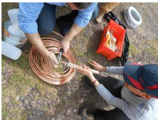
Fotografías G Escalera con tornillo de banco, tubo de cobre de 3/8" y equipo muestreador de gas.
