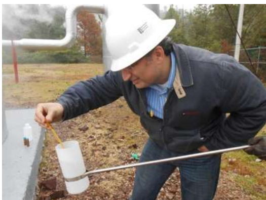
Fotografías B. Medición de temperatura, pH y conductividad eléctrica a las muestras de agua.
