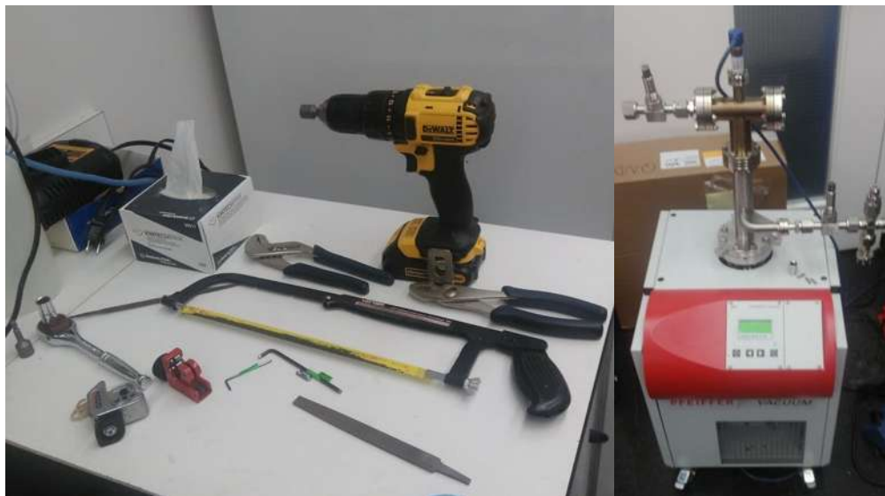
Fotografías R Herramientas necesarias para el manejo de los sistemas de muestreo (Izquierda) y Sistema de vacío para la extracción y purificación de los gases nobles (derecha).
