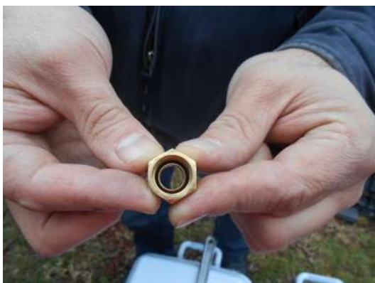
Fotografías H Conexiones/reductores para tomar la muestra de gas.
