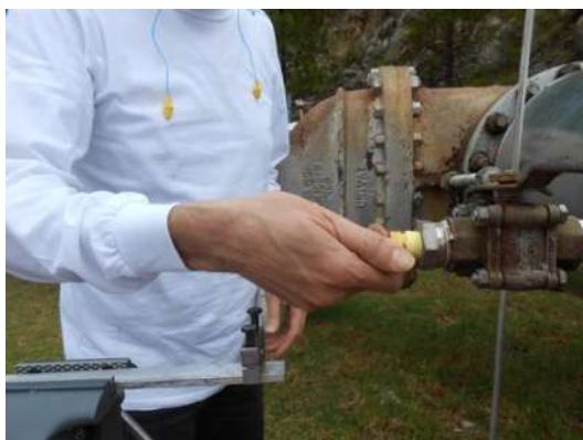
Fotografías H Conexiones/reductores para tomar la muestra de gas.
