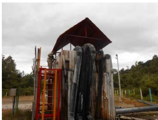
Fotografías C Recolección de muestras del agua de inyección, en el cabezal y en una caja rompedora.
