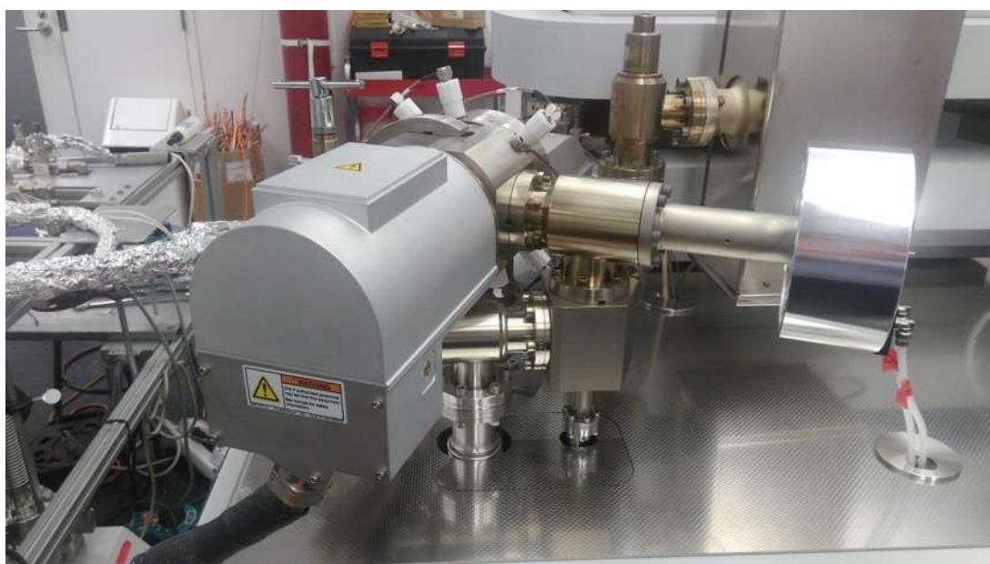
Fotografías S Espectrómetro de masas Thermo Scientific® Helix SFT.
