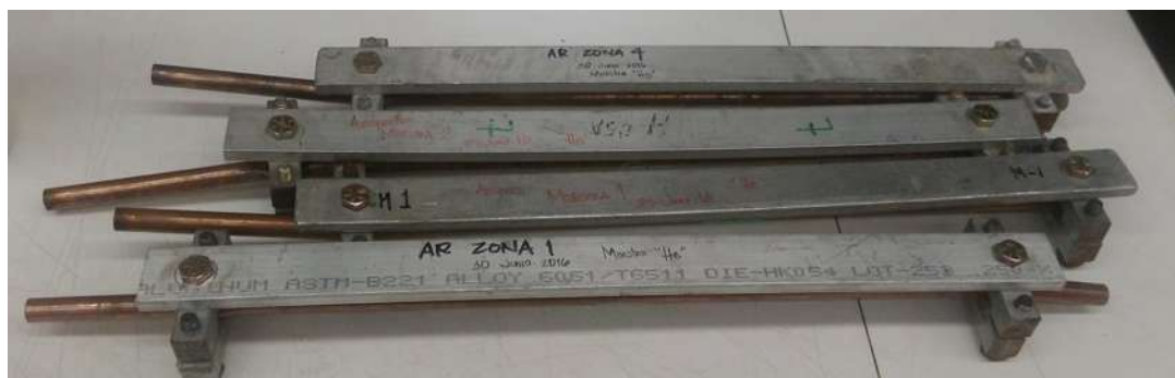
Fotografías Q Sistema de muestreo que consta de: 1 tubo de cobre 3/8in 1barra de acero y 2 prensas o pinzas sujetadoras a los extremos.
