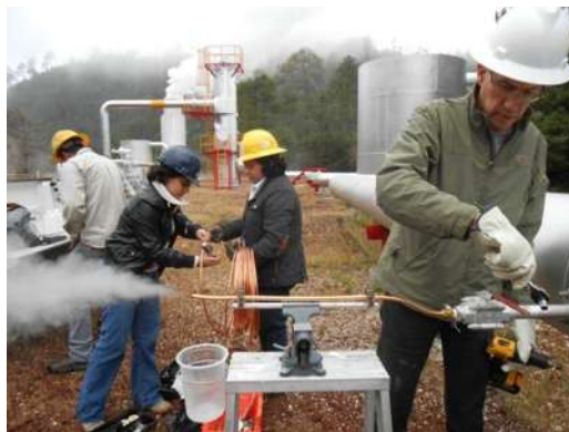
Fotografías J Se abre lentamente la válvula y se deja fluir el gas.
