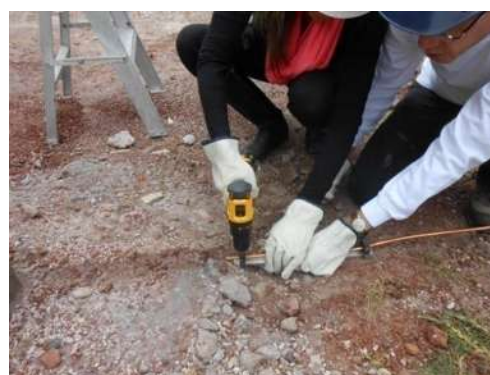
Fotografías N Se conecta el sistema de muestreo, se cierran las prensas y se sellan los tubos y al final se libera la presión antes de cortar el tubo.
