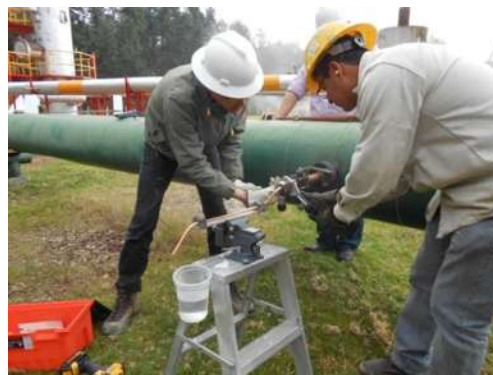
Fotografías K Se cierran las prensas con el taladro para sellar el tubo. Se libera presión antes de desconectar la muestra contenida en el tubo.
