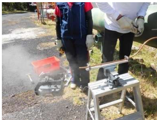
Fotografías / Se corta tubo de cobre de la longitud necesaria, se monta sobre la barra con las prensas en el tornillo de banco.
