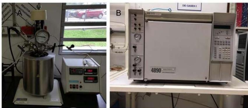
**Figura 27.** Reactor y cromatógrafo utilizados.
