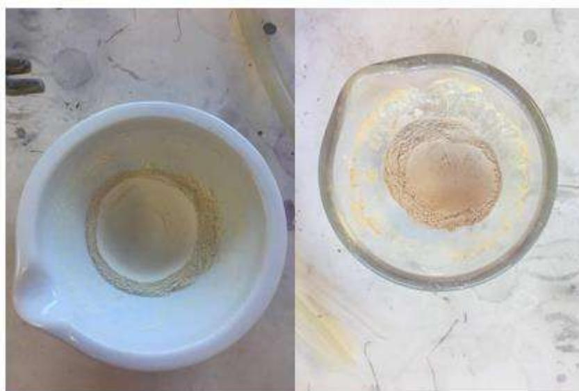
**Figura 13.** Preparación de catalizadores mediante co-impregnación.
