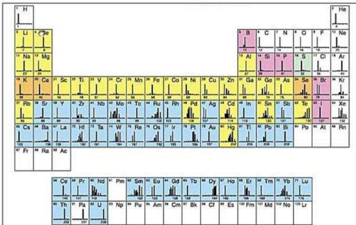
Figura 15. Elementos detectables por análisis ICP-MS.
