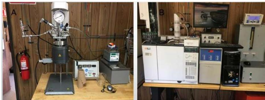
**Figura 26.** Reactor y cromatógrafo utilizados.
