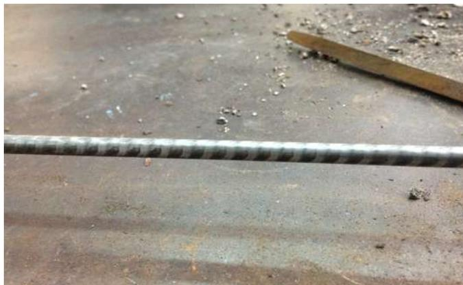
*Figura 3. Corrugaciones en el acero de refuerzo del concreto.*
