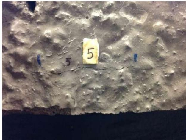
*Figura 14. Caracterización de grietas ocasionadas por corrosión.*
