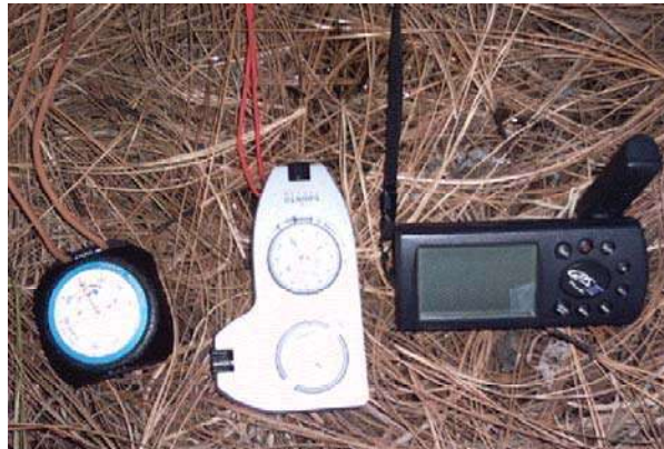
Figura 6.- Altímetro, clinómetro y GPS utilizados en las mediciones fisiográficas.
