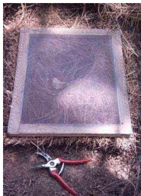
Figura 13.- Obtención de muestra de hojarasca con malla y tijeras.
