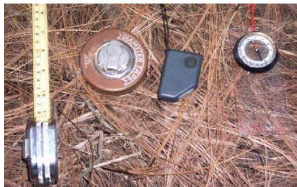
Figura 7.- Longímetro, cinta diamétrica, Hipsómetro y brújula, utilizados en mediciones dasométricas.
