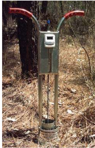
Figura 12.- Infiltrómetro de doble anillo
