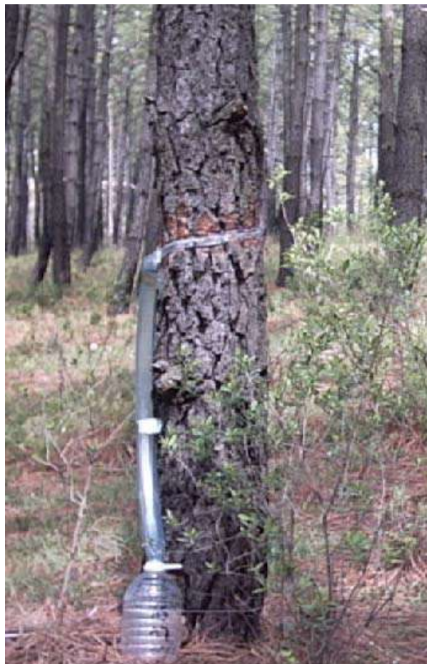
Figura 10.- Material para medición del flujo caulinar.
