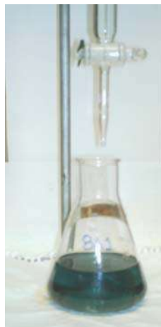
Figura 11. Determinación de Carbono Orgánico método de Walkley y Black ( op. Cit. ).
