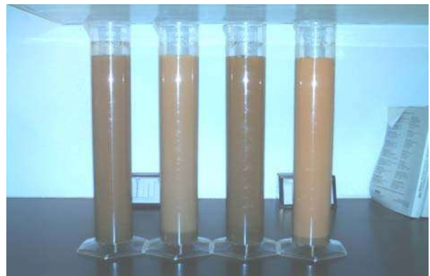
Figura 9. Determinación de textura, método del hidrómetro de Bouyoucos.
