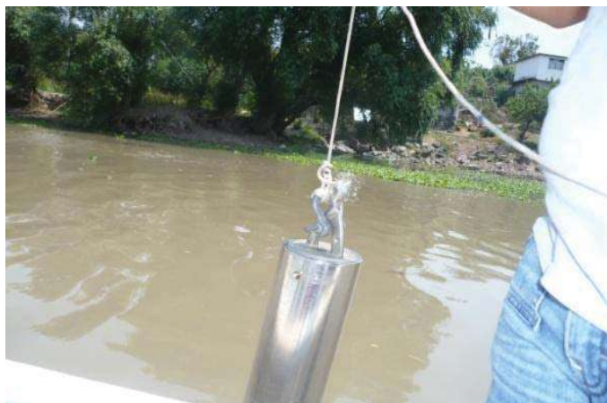
Figura 9´. Colector de agua para oxígeno disuelto en muestras de fondo
