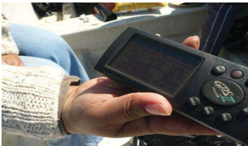
Figura 10. Geoposicionamiento con el receptor GPS Garmin Mod. II Plus
