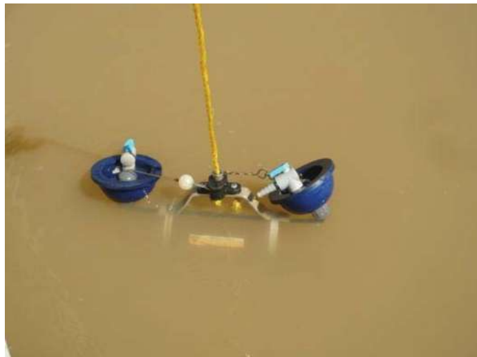
Figura 9. Botella de Van Dorn para muestras de agua a diferente profundidad
