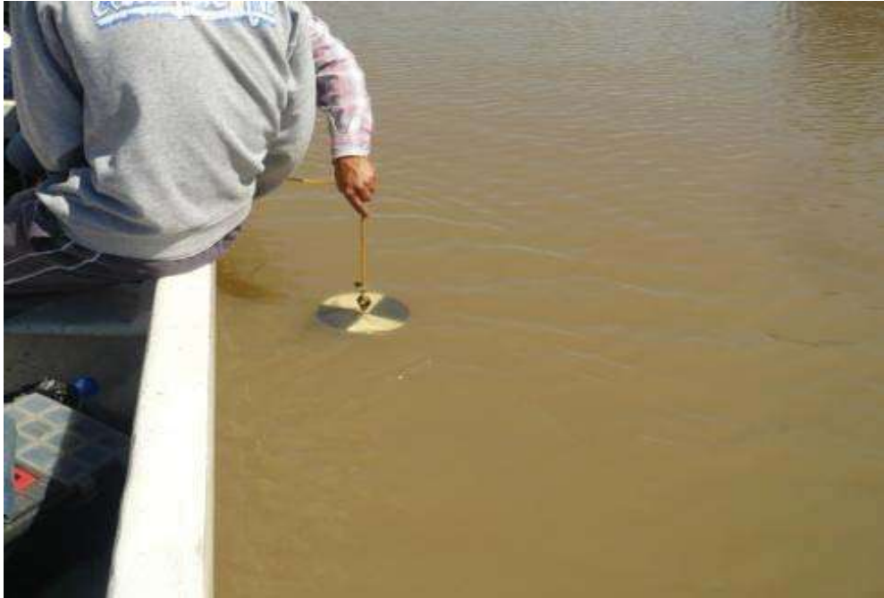
Figura 8. Medición de la visibilidad mediante el empleo del disco de Secchi
