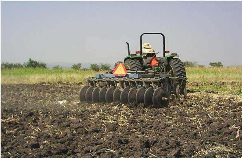
Figura 3.- El rastreo del suelo fue efectuado para reducir el tamaño de los terrones grandes y permitir un suelo mullido.
