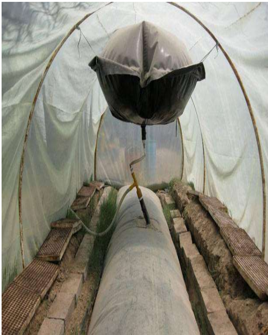
Figura 3.1 Modelo de un Sistema Biobolsa de geomembrana para pequeñas granjas (figura de vista a lo ancho)
