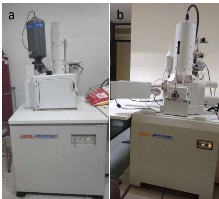
Figura 30. Microscopio electrónico de barrido (MicroNa) y microscopio electrónico de barrido de emisión de campo (UAMI)
