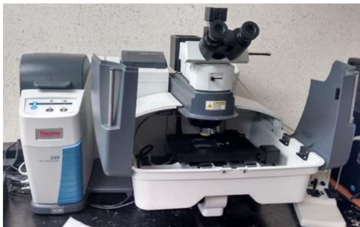
Figura 32. Espectrómetro Raman (UV-MicroNa)
