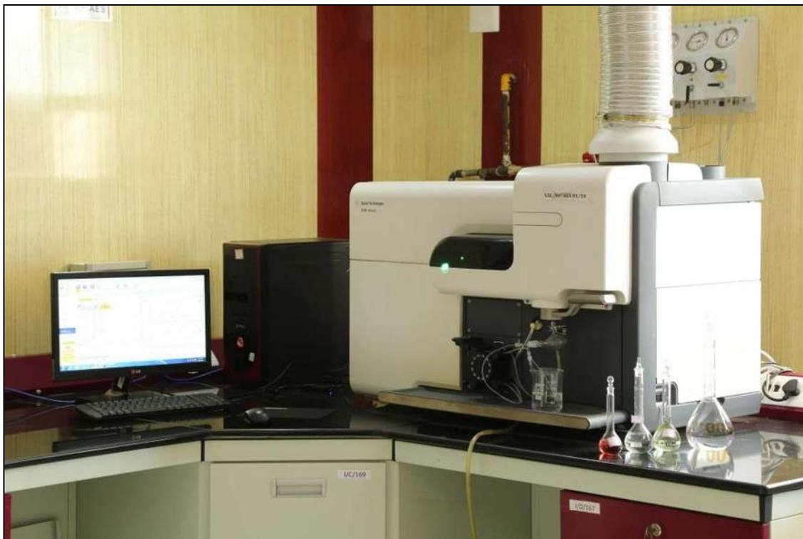
**Figura 3.6** Espectrómetro de emisión atómica por plasma (Agilent Technologies 4100 MP-AES. Laboratorio de fisicoquímica y fluidos complejos, Facultad de ciencias físico-matemáticas, UMSNH).
