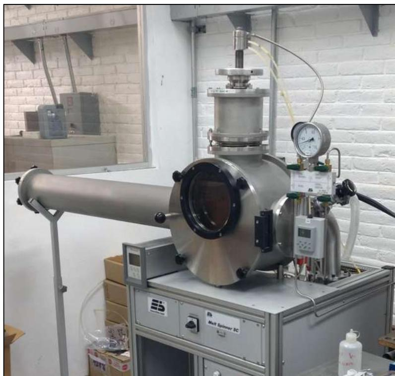
**Figura 3.4** Horno proceso de colada en bloque enfriante giratorio EDMUND BÜHLER (chill block melt spinning CBMS), utilizado para el colado de las cintas.
