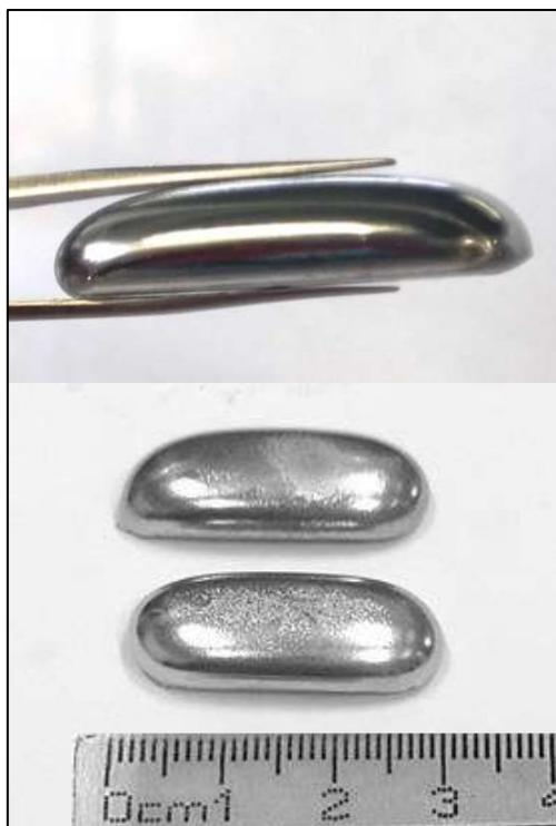
**Figura 3.2** Lingotes de aleación  $Zr_{58}Co_{21}Al_9Ag_{12}$  obtenidos por fusión de arco con atmósfera de Ar.
