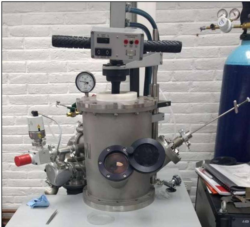
**Figura 3.1** Horno de arco eléctrico EDMUND BÜHLER (Arc-Melter AM), utilizado para la fusión y homogenización del sistema de aleación.
