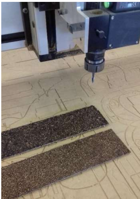
Figura 23. Tablero de partículas a base de lignina despolimerizada, maquinado por medio de vaciado, no se logró medir la rugosidad de superficial debido a la porosidad
