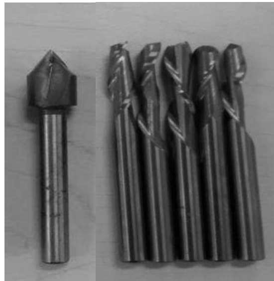
Figura 9. Herramientas de corte utilizadas en la investigación: a) cortador de punta V90, b) cortador recto 2 filos y c) cortador recto un filo
