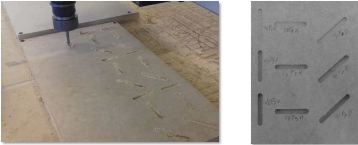
Figura 14. Maquinado de la probeta de MDF con los maquinados del diseño experimental preliminar
