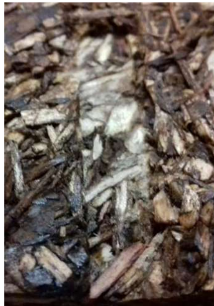
Figura 23. Tablero de partículas a base de lignina despolimerizada, maquinado por medio de vaciado, no se logró medir la rugosidad de superficial debido a la porosidad
