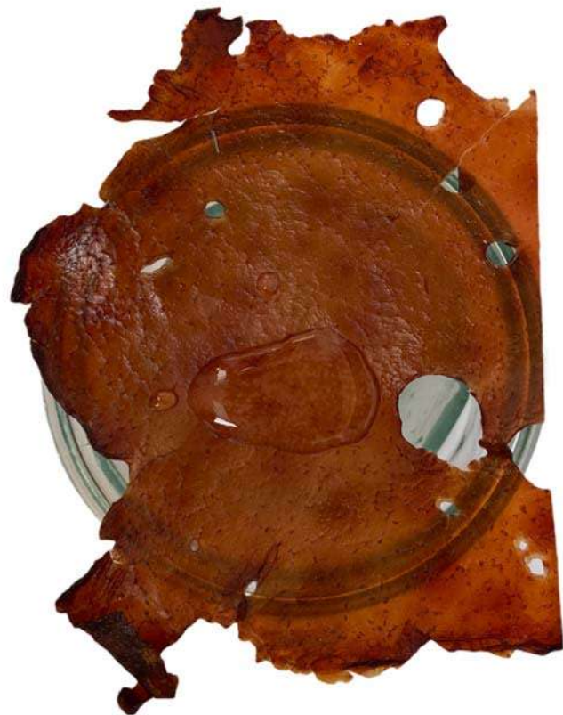
Fig. 165 Prueba de reblandecimiento al agua, lámina de vino tinto
