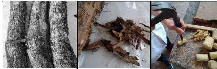
**Figura 4.** Materia prima: a) Madera, b) Descortezado y c) Astillado.
