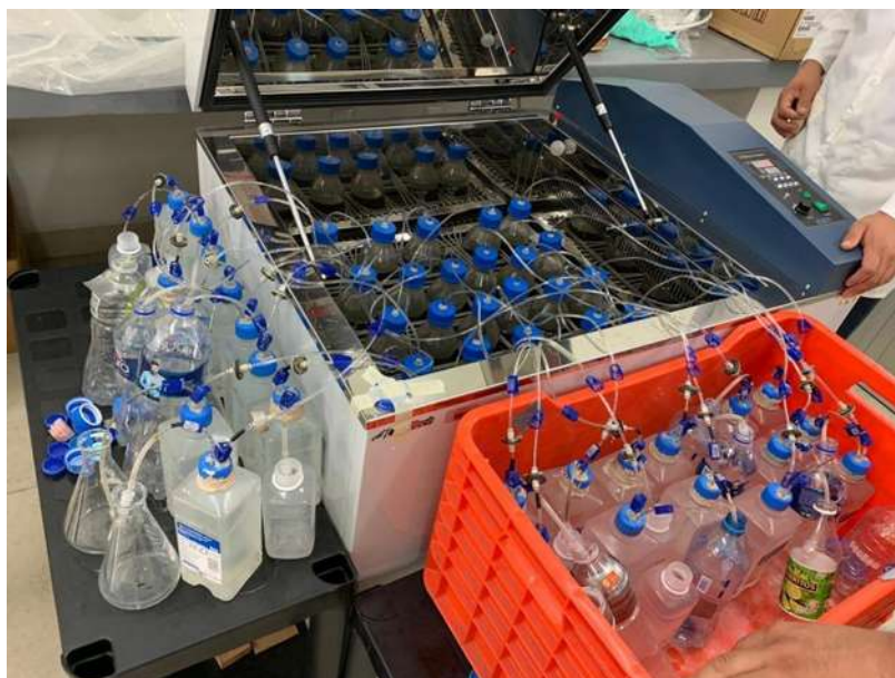
Figura 7. Pruebas de Potencial Bioquímico de Metano (BMP).
