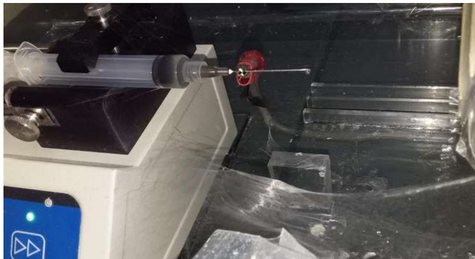
Figura 31. Fibras de Cel/PVA electrohiladas entre la bomba y el colector
