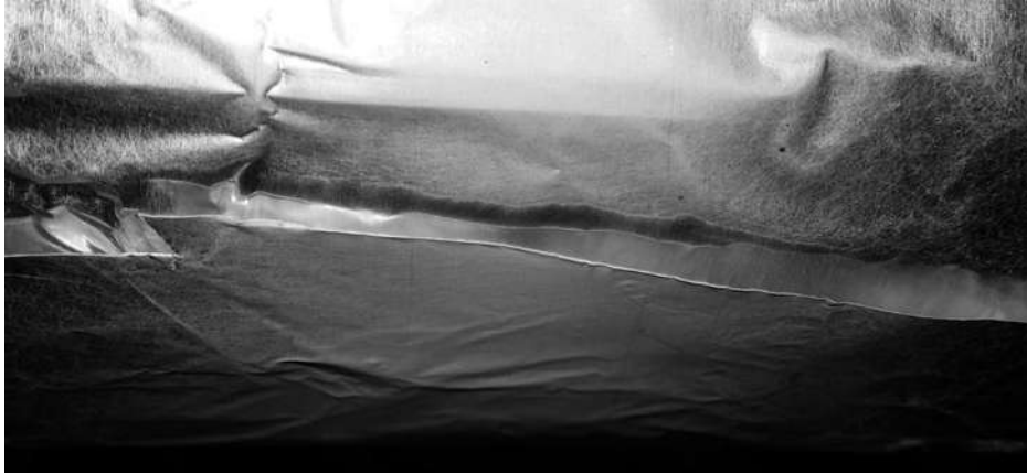
Figura 3. Fibras electrohiladas depositadas al azar en colector de aluminio
