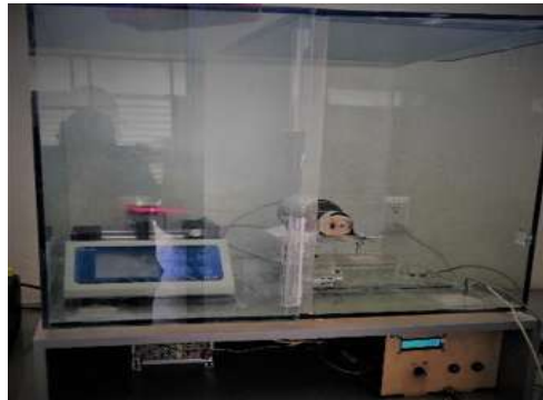
Figura 30. Equipo de electrohilado usado para la obtención de fibras
