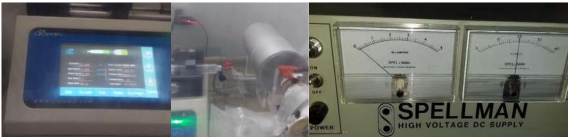
Figura 14. Bomba inyectora, jeringa y tambor colector, fuente de poder
