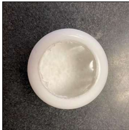
Figura 4. Diseño de contenedor para prueba de permeabilidad al vapor de agua. Frasco estilo pomadera con perforación en tapa de 25.4 mm
