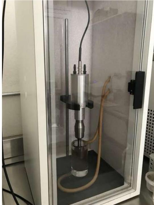
**Figura 5. Extracción asistida por ultrasonido Sonics, modelo: VC505.**
