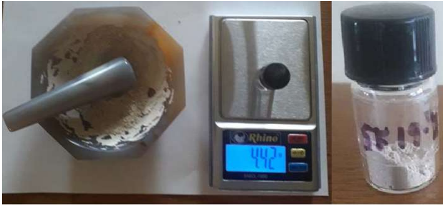
Figura 1. Preparación de las muestras de sedimento. A la izquierda se tiene el mortero con el que se realizó el pulverizado y la balanza con el polvo pesado. A la derecha se tiene el contenedor del polvo de ETR con su etiqueta correspondiente.
