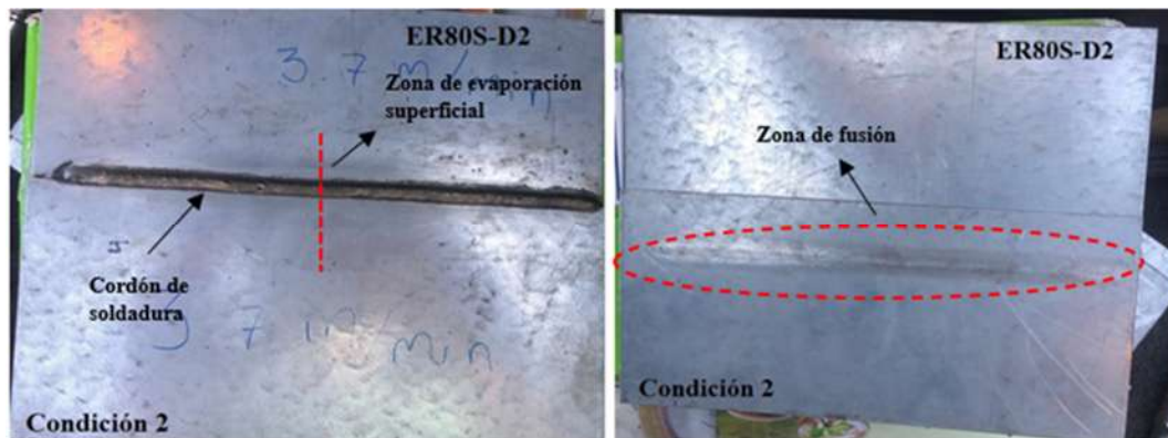
Figura 4.6 Unión soldadas con el electrodo ER80S-D2 mediante el proceso GMAW-P. C2
