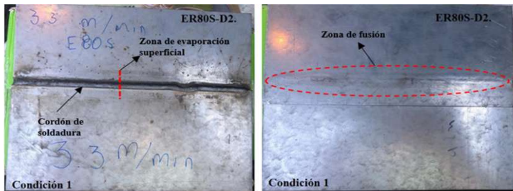
Figura 4.5 Unión soldadas con el electrodo ER80S-D2 mediante el proceso GMAW-P. C1.
