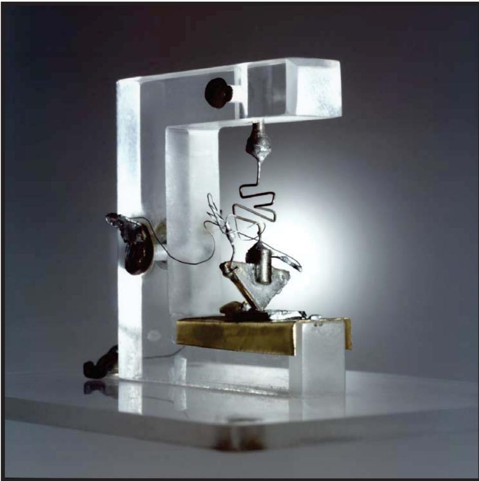
Ilustración 16. Transistor. El primer transistor desarrollado por los Laboratorios Bell.
