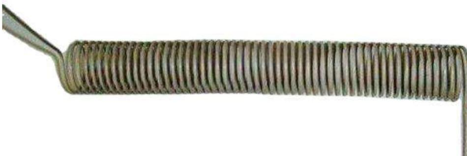
*Figura 3.15. Imagen representativa de la configuración final de la resistencia tipo kanthal.*
