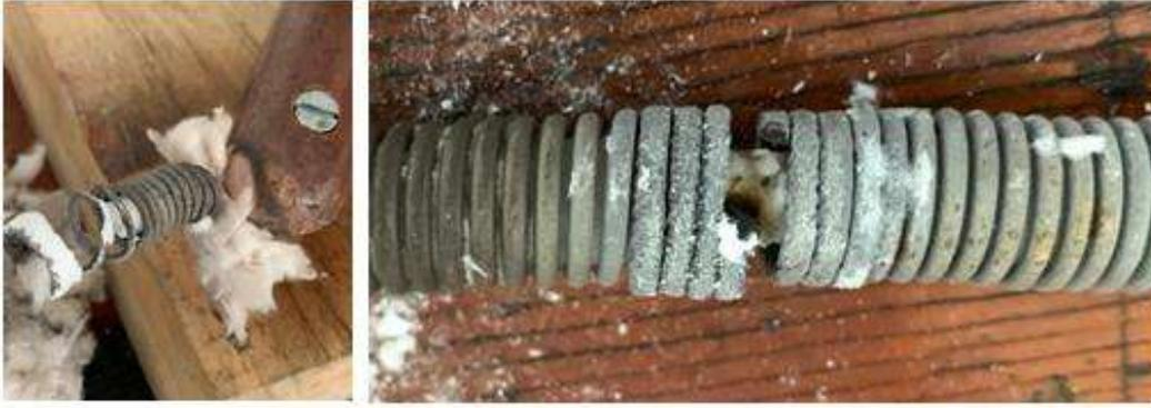
Figura 3.21. Desgaste de material por concentración de temperatura.
