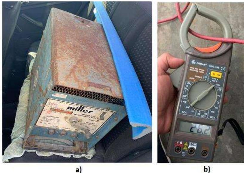
Figura 3.10. a) Fuente de poder, b) Corriente mínima transmitida por la fuente de poder.
