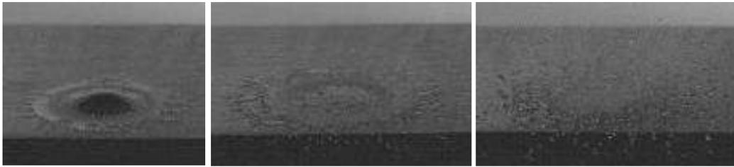
Figura 4.6. Impacto de gota de 3.5mm de diámetro sobre superficie caliente a 500°C.
