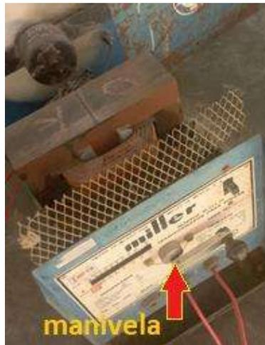
Figura 3.20. Variación de corriente por medio de la fuente de poder.
