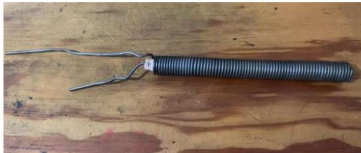
Figura 3.5. Resistencia hecha de alambre kanthal A-1, calibre 18.
