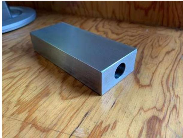
Figura 3.4. Placa de acero inoxidable AISI 304.
