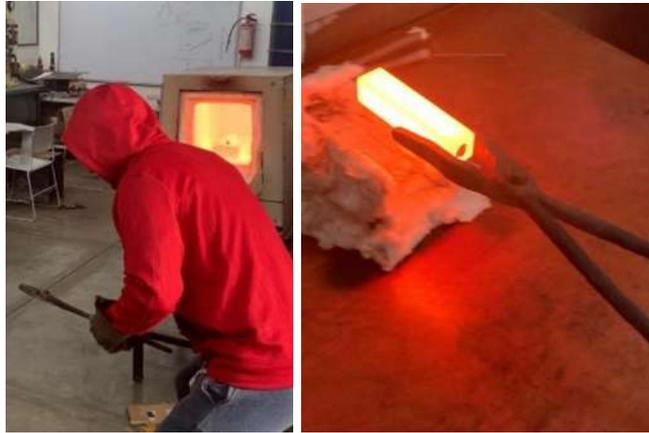
Figura 3.19. Calentamiento de placa experimental a través de una mufia.
