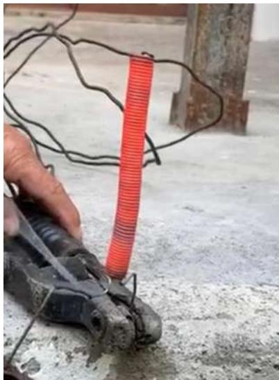
Figura 3.6. Prueba de calentamiento de resistencia.
