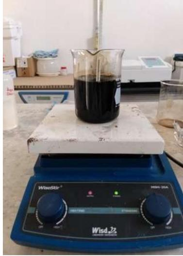
*Figura 13. Lavado de la solución de óxido de grafeno*
