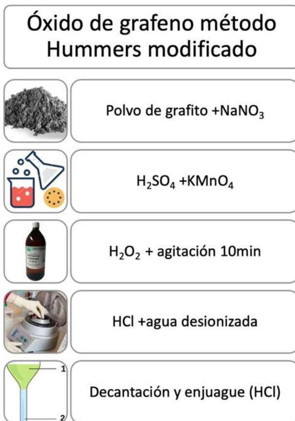
Figura 10. Diagrama para la síntesis de OG
