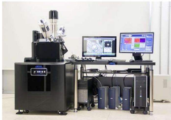
Figura 19. Microscopio electrónico de barrido JEOL JSM-IT300 (Tomada de [enesmorelia.unam.mx](http://enesmorelia.unam.mx))
