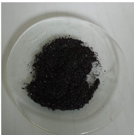
Figura 33. Polvo de OG. Material resultante de la síntesis de grafito.
