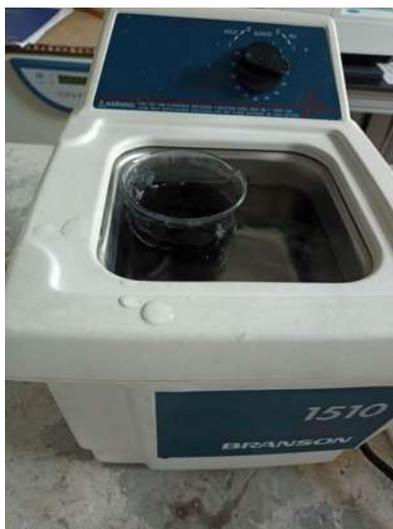
Figura 34. Disolución de OG en agua destilada en la tina Branson 1510 de ultrasonido
