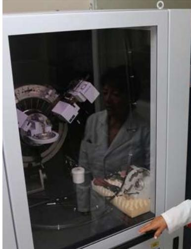
Figura 18. Sistema de difracción de rayos X modelo D8 ADVANCE DAVINCI (tomada de [www.iim.umich.mx](http://www.iim.umich.mx))
