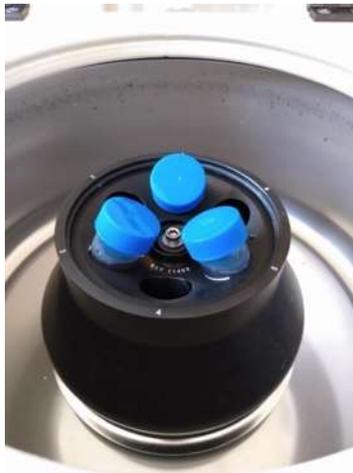
*Figura 14. Solución de óxido de grafeno a centrifugar*
