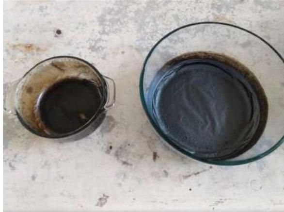
*Figura 15. Óxido de grafeno después del secado en horno*
