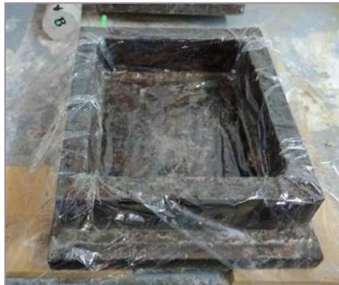
Figura 5.10 Molde impregnado de aceite y recubrimiento plástico.
