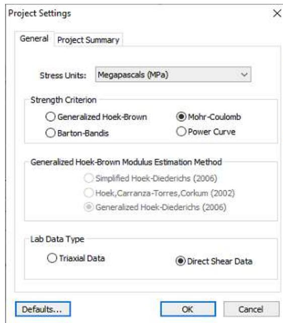
Figura 4.35 Configuración de proyecto para datos de corte directo.
