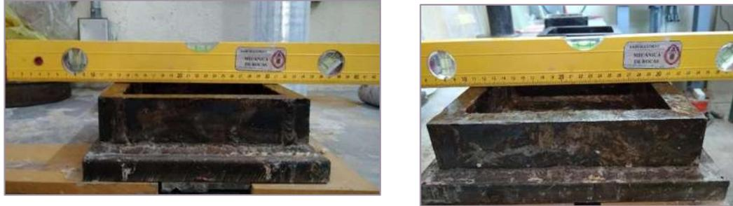
Figura 5.9 Alineación de molde inferior en sentido transversal y longitudinal con nivel de mano.
