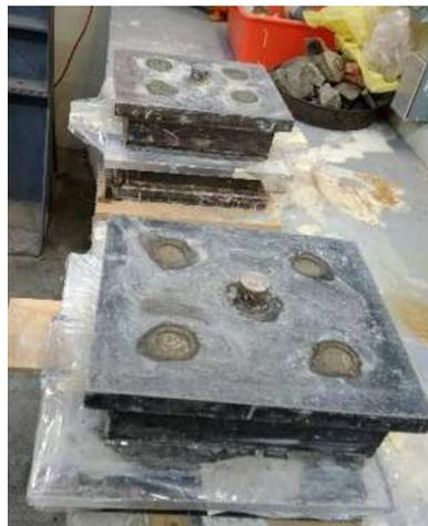
**Figura 5.13 Confinamiento de molde superior.**
