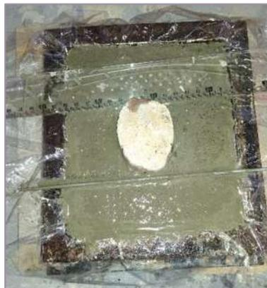
Figura 5.11 Confinamiento de cara inferior.
