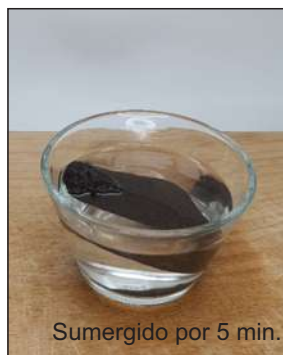
Figura 114 Foto aplicando pruebas manuales al material de borra de café + almidón de yuca.
