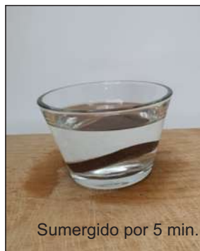
Figura 144 Foto aplicando pruebas manuales al material de borra de café + Agar.
