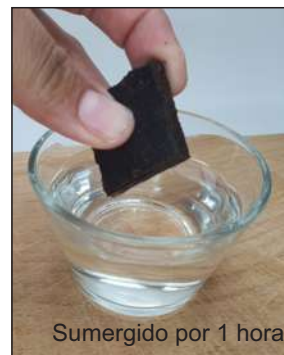
Figura 109 Foto aplicando pruebas manuales al material de borra de café + resina de pino.
