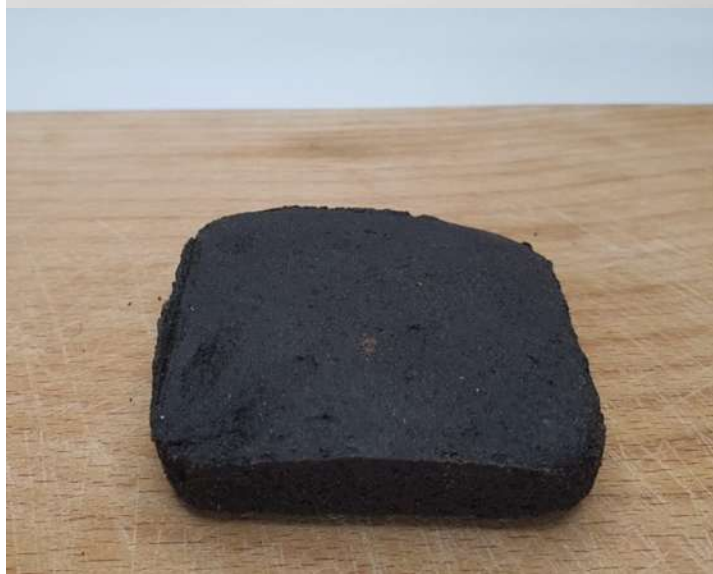
Figura 112 Foto resultado material de la Borra de café + Almidón de yuca.
