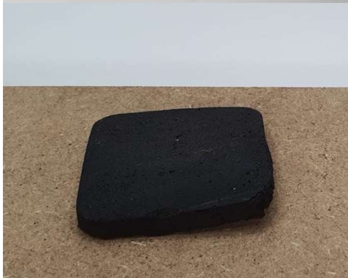
Figura 137 Foto resultado material de la Borra de café + Cola de conejo.
