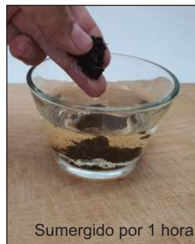
Figura 129 Foto aplicando pruebas manuales al material de borra de café + cáscara de plátano.
