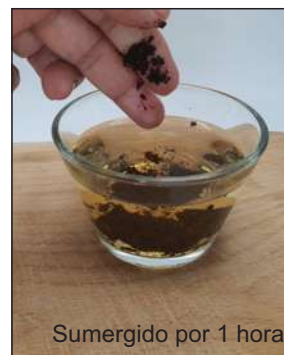
Figura 124 Foto aplicando pruebas manuales al material de borra de café + cáscara de naranja.
