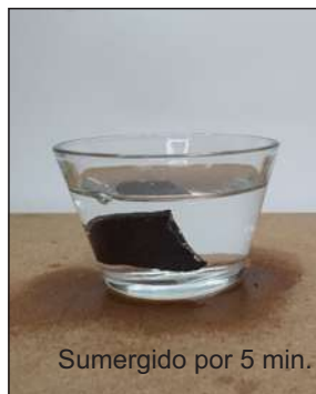
Figura 139 Foto aplicando pruebas manuales al material de borra de café + Cola de conejo.
