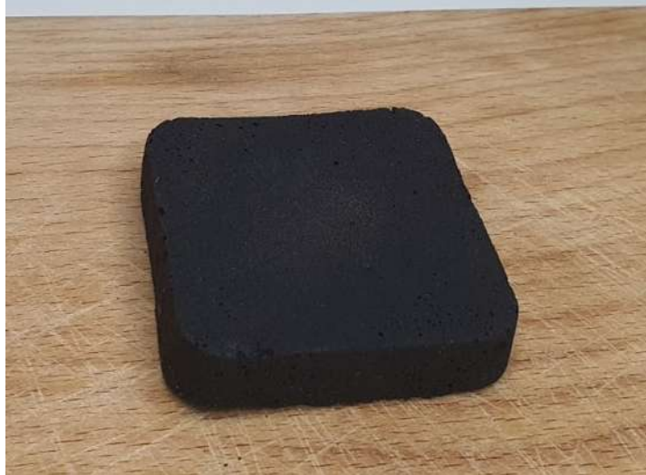
Figura 132 Foto resultado material de la Borra de café + Grenetina.
