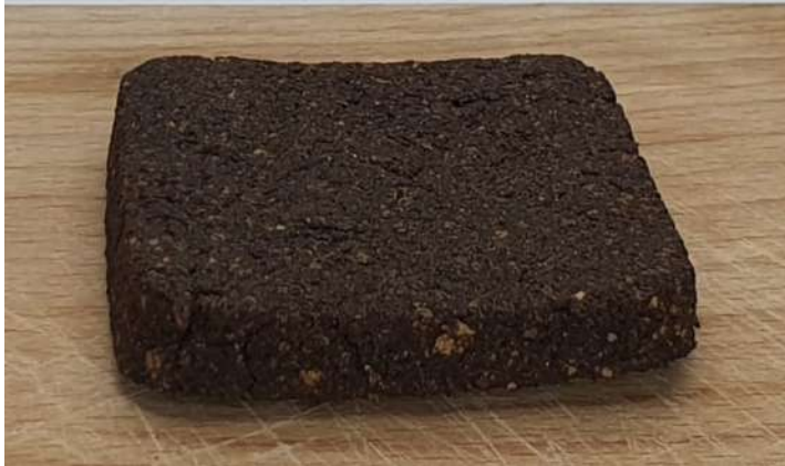
Figura 122 Foto resultado material de la Borra de café + Cáscara de naranja.
