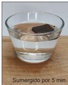
Figura 129 Foto aplicando pruebas manuales al material de borra de café + cáscara de plátano.
