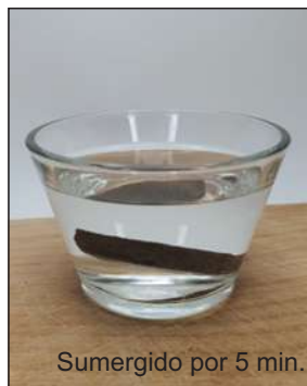
Figura 109 Foto aplicando pruebas manuales al material de borra de café + resina de pino.
