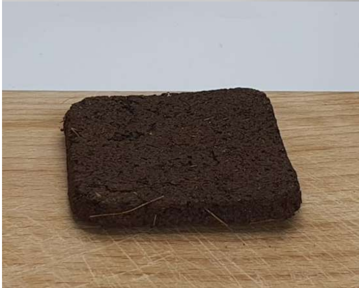
Figura 127 Foto resultado material de la Borra de café + Cáscara de plátano.
