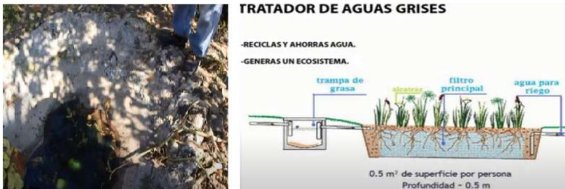
**Imagen 13** Biofiltro y esquema explicativo (CEJM, 2018a: min 35:49 - 37:26)
