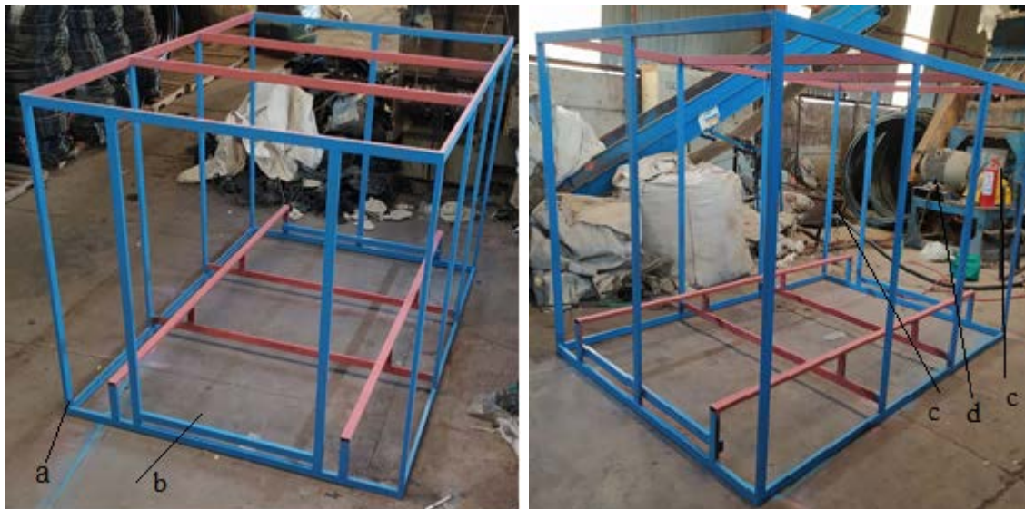
Figura 8. Diseño exterior de la estructura de la cámara de termotratamiento. a) Estructura de la cámara b) entrada de la cámara c) zona para los quemadores d) zona para el ventilador.
