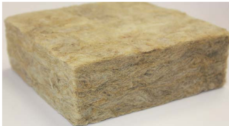
Figura 4. Aislante térmico utilizado en la construcción del horno de termotratamiento (lana mineral).
