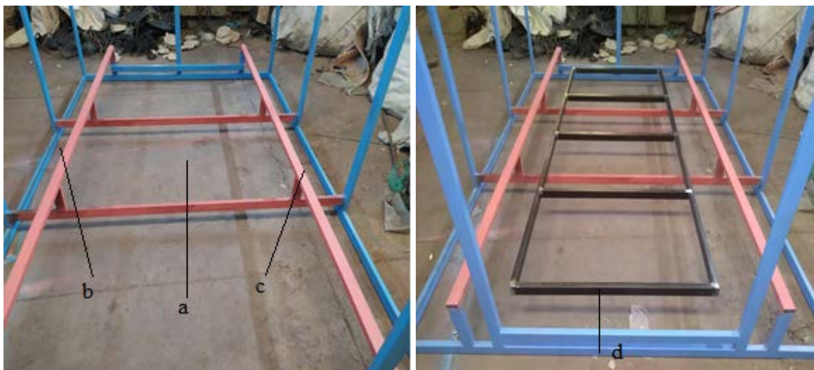
Figura 8. Diseño exterior de la estructura de la cámara de termotratamiento. a) Estructura de la cámara b) entrada de la cámara c) zona para los quemadores d) zona para el ventilador.
