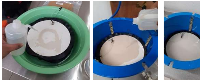
Figura 116. Proceso de saturación de los platos cerámicos durante 8 a 24 horas.
