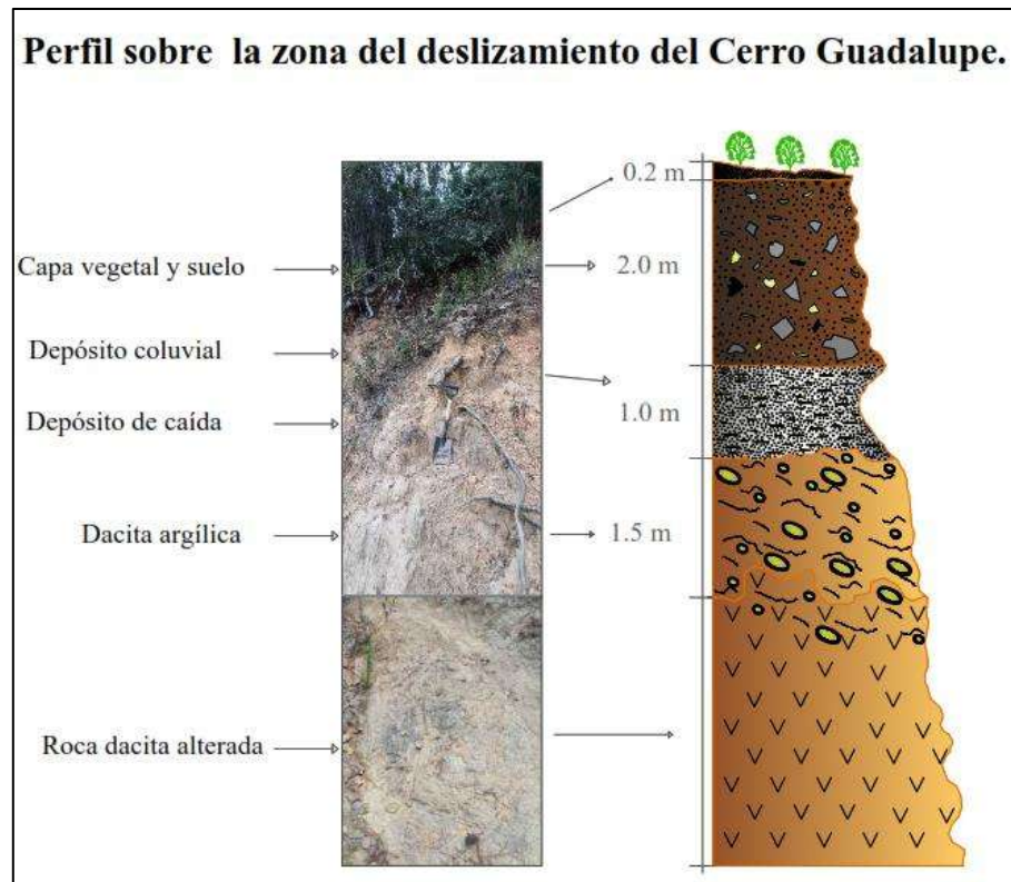
Figura 67. Perfil estratigráfico sobre la zona del deslizamiento en la ladera SE del Cerro Guadalupe
