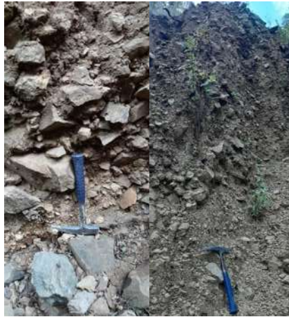
Figura 64. Depósito coluvial sobre la coordenada X=365093 m, Y=2170476 m y Z=2769 msnm, de un espesor superior a los 6 m, presentando clastos de composición andesítica de forma angulosa con tamaños de 0.10 m a 0.90 m inmersos en una matriz de suelo arenoso de color café.
