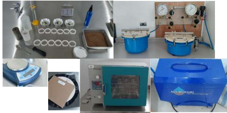
Figura 113. Equipo y material utilizado en la prueba para determinar la SWCC en laboratorio.
