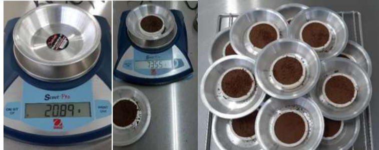
Figura 124. Determinación del peso húmedo de las muestras de suelo.
