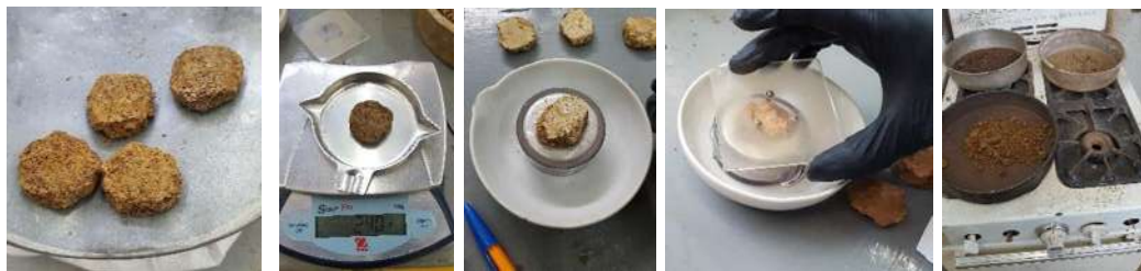
Figura 35. Determinación de humedad natural y PVHC.
