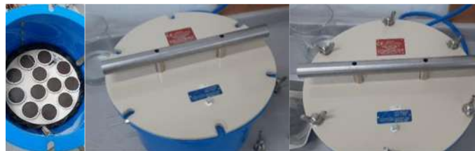
Figura 119. Colocación de la tapa del extractor y colocación de los tornillos para mantener la presión de aire.
