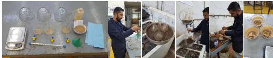
Figura 39. Prueba para determinación de densidad de sólidos ( S_s ).
