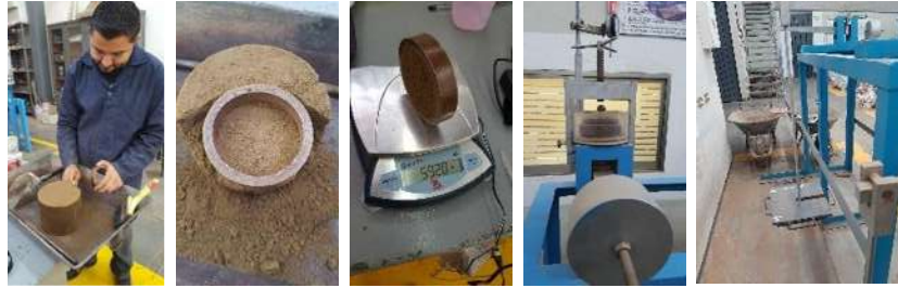
Figura 38. Proceso de prueba de consolidación unidimensional.
