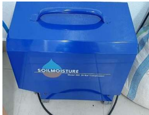
Figura 120. Compresor SOILMOISTURE para 20 bares de presión.
