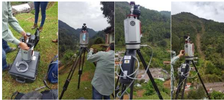
Figura 27. Equipo utilizado para obtener la topografía de la ladera fue realizado con el Laser Scanner RIEGL VZ-1000.
