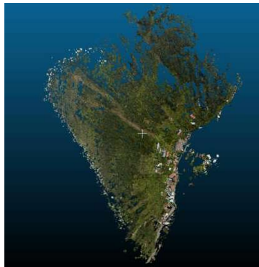
Figura 29. Nube de puntos del levantamiento topográfico, utilizando el programa CloudCompare.
