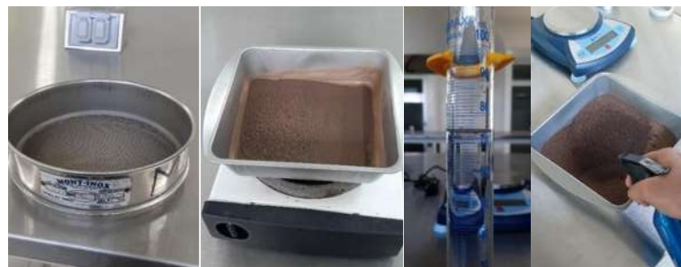
Figura 114. Proceso de remoldeo para obtener las muestras que se utilizaran en la prueba.
