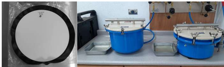
Figura 46. Plato Cerámico para presión de 1 bar y extractores modelo 1600 y 1500F1.
