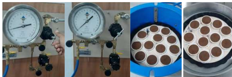
Figura 123. Se retiran las muestras una vez deja de extraer agua (cuando se mantenga en equilibrio).
