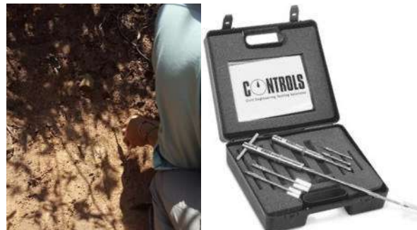
Figura 26. Medición in situ de propiedades mecánicas con penetrómetro de bolsillo y molinete de bolsillo para inspección del terreno.
