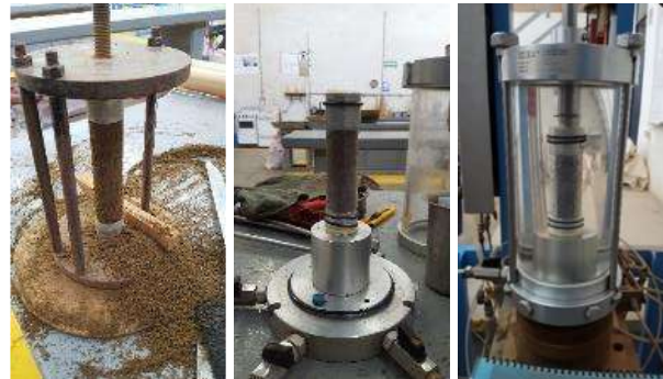
Figura 41. Proceso de la prueba de compresión Triaxial realizada a las muestras de suelo.
