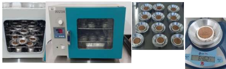
Figura 125. Determinación del peso seco de las muestras de suelo.
