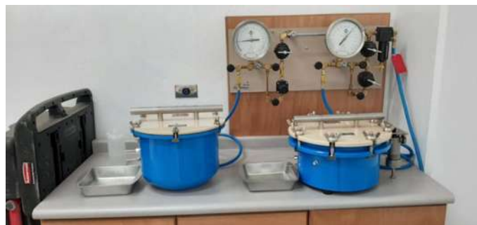
Figura 121. Configuración del colector con sus estaciones (extractor 1600 y 1500F1) ya en funcionamiento.
