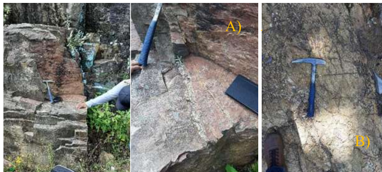
Figura 61. A) Roca con poca alteración presentando color café-rojizo poco alterada con planos de fracturas (orientación 345^{\circ}\text{N}/72^{\circ} ; 40^{\circ}\text{N}/78 ) y B) Roca dacita color amarillento alterada hidrotermalmente y con fracturación de forma enrejada.
