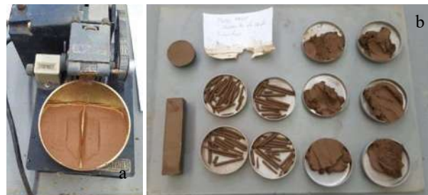
Figura 37. a) Determinación del límite líquido en suelos con la copa de Casagrande y colocadas en recipientes de aluminio para determinar las diferentes humedades que presenta la muestra de suelo; b) límite plástico con los rollitos de 1mm de diámetro y colocados en las capsulas de aluminio; así como las muestras de CL y CV.
