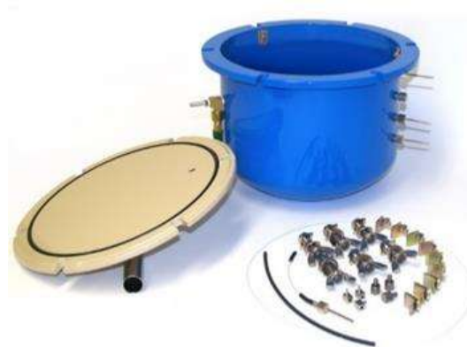
Figura 44. Extractor de placa de presión 5 bares modelo 1600.
