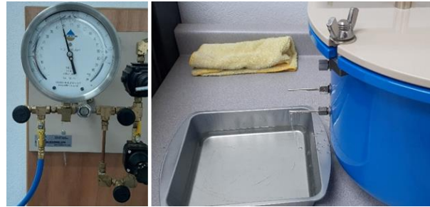
Figura 122. Expulsión de la humedad en los especímenes de suelo aplicando una presión de 3 bar.
