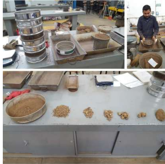
Figura 36. Determinación de la composición granulométrica de material.
