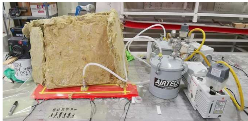
Figura 3 29 Control de la temperatura durante el proceso de infusión para mantener un curado uniforme
