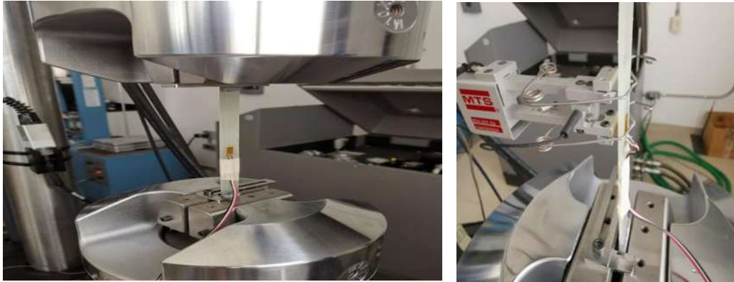
Figura 4 6 Alineación de la probeta y posicionamiento del extensómetro axial.
