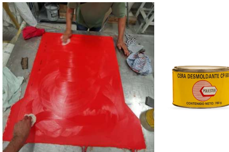
Figura 3.10 Aplicación de capas de cera desmoldante sobre el molde
