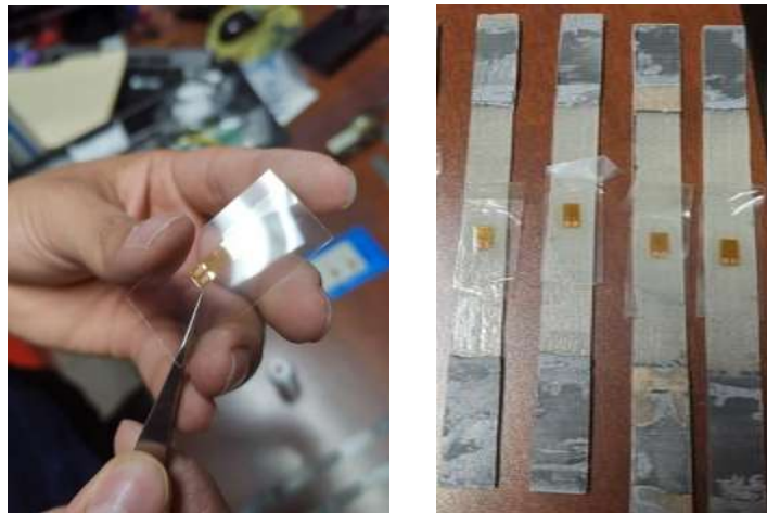
Figura 3 35 Colocado y pegado de la galga extensiométrica sobre las probetas
