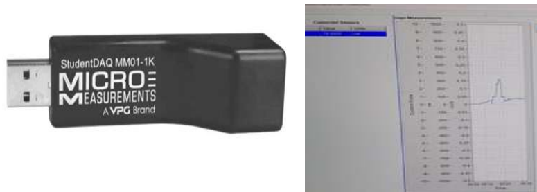
Figura 3 38 Micro measurements, para medir las micro deformaciones
