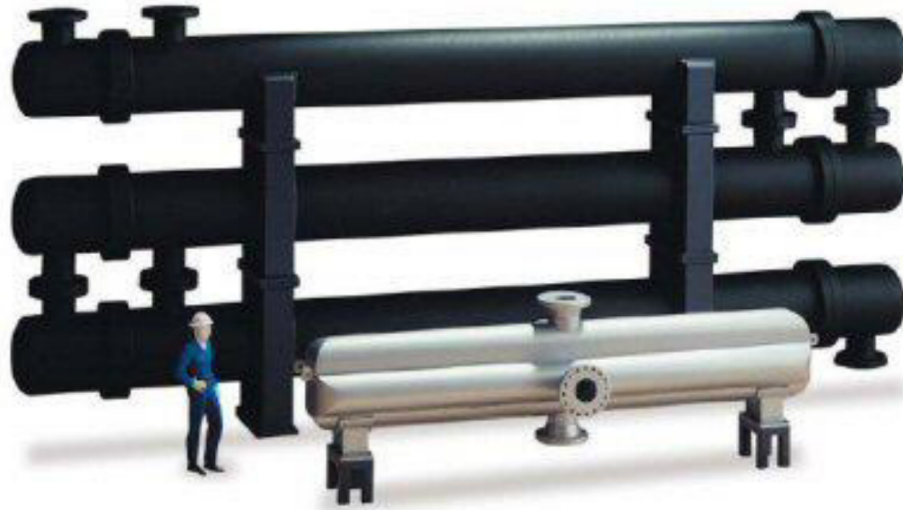
Figura 3.3. Comparación entre un STHE y un PCHE, [146].
