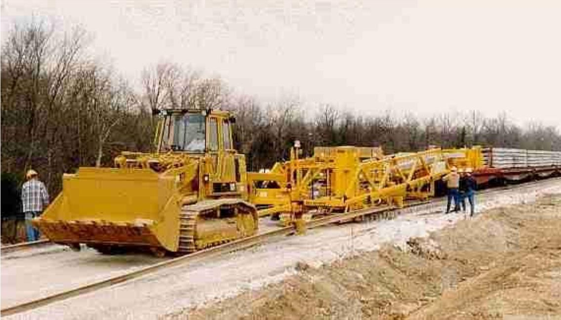
Fig. 27.- Máquina de construcción de nuevas vías, totalmente mecanizada (modelo NTC)
