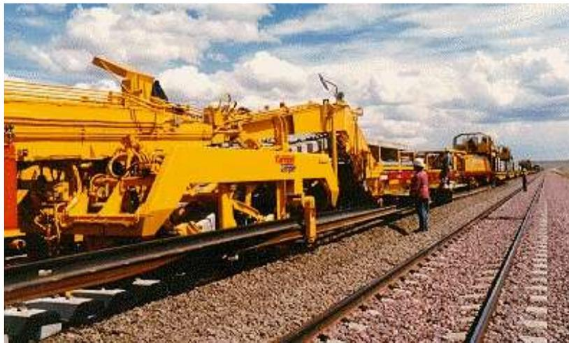
Fig. 29.- Máquina fileteando soldaduras de los rieles (rebaba sobrante)
