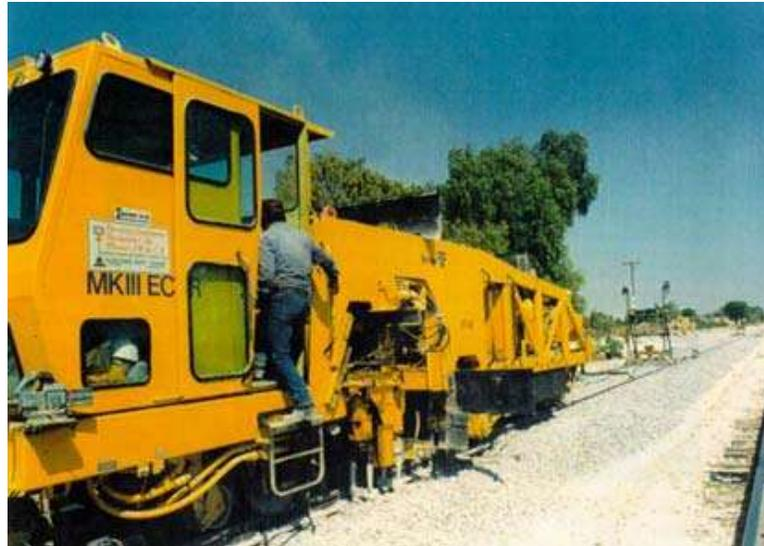
Fig. 19.- Multicalzadora Tamper Mark III
