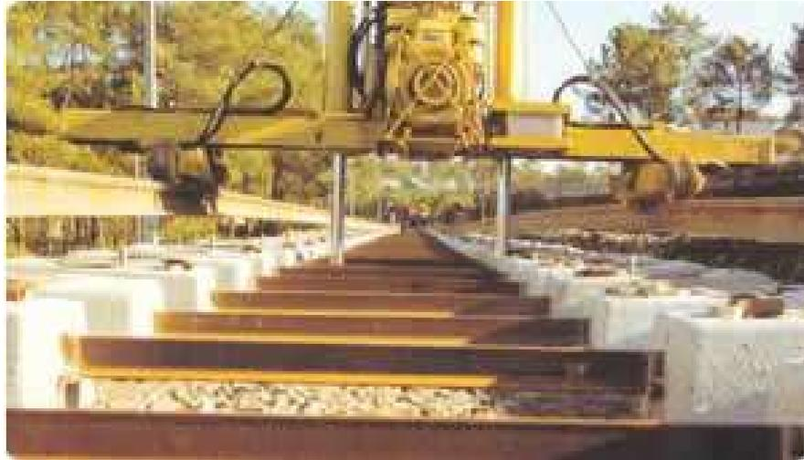
Fig. 16.- Máquina Posicionadora, levanta y monta rieles ubicados a ambos lados
