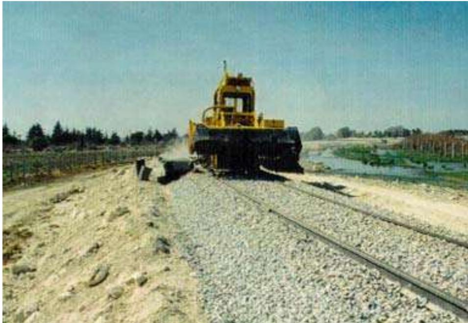
Fig. 21.- Reguladora de balasto, con aditamento para barredora
