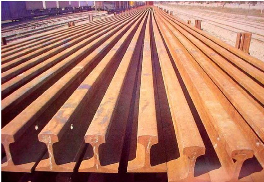
Fig. 23.- Riel continuo de 115 lb/yd, sección RE, dureza estándar
