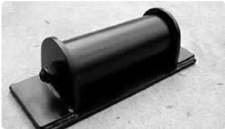
Fig. 14.- Rodillo para auxiliar en la descarga de los rieles
