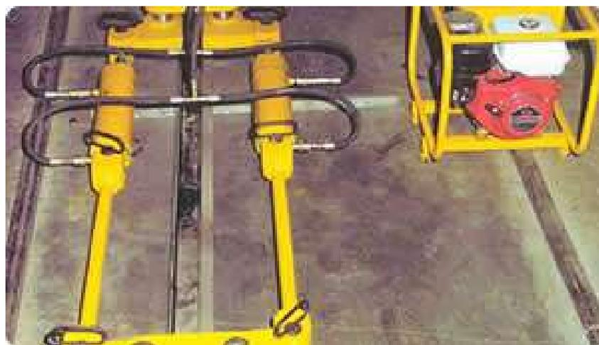
Fig. 23.- Liberador de tensión, hidráulico, con motor de gasolina
