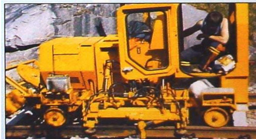
Fig. 17.- Máquina motorizada, instala simultáneamente cuatro grapas en un durmiente
