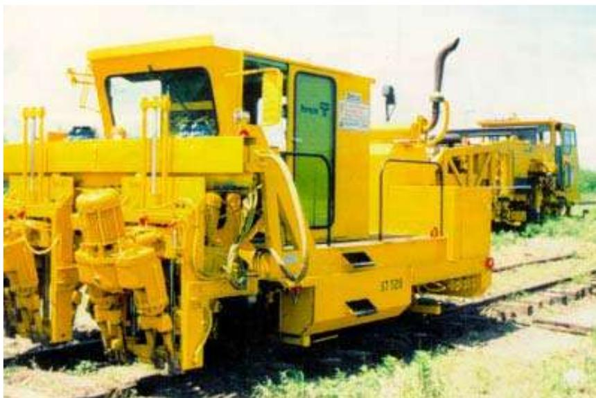
Fig. 18.- Multicalzadora Júnior Tamper, utilizada para realizar primer levante
