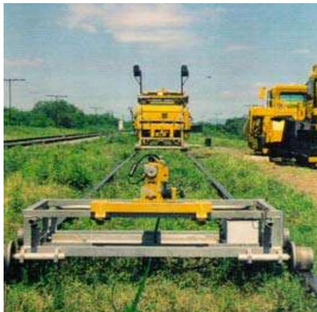
Fig. 20.- Equipo de rayo láser, para Mark III
