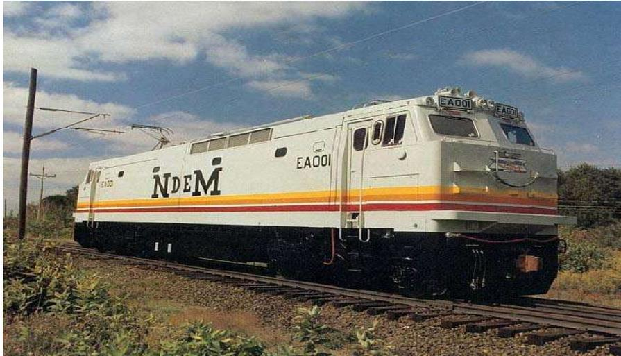
Fig. 19.- Locomotora General Eléctric, clase E60C, 6000 HP
