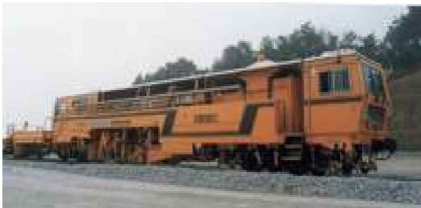
Fig. 31.- Máquina calzadora con sistema de medición de MODEM óptico
