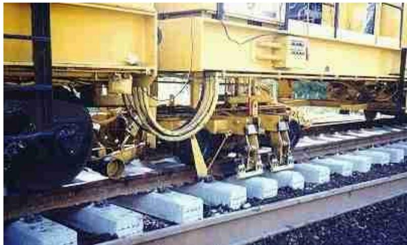
Fig. 30.- Máquina aplicando la fijación correspondiente (Clip Pandrol)
