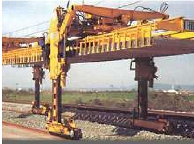
Fig. 10.- Pórtico hidráulico, para cargar tramos de vía ensamblada
