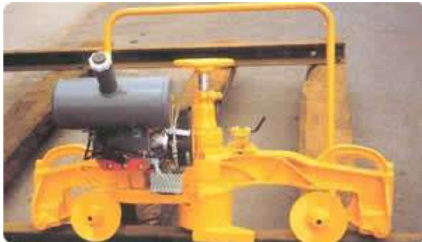
Fig. 25.- Esmeriladora de riel, con motor a gasolina (peso 70 kg)
