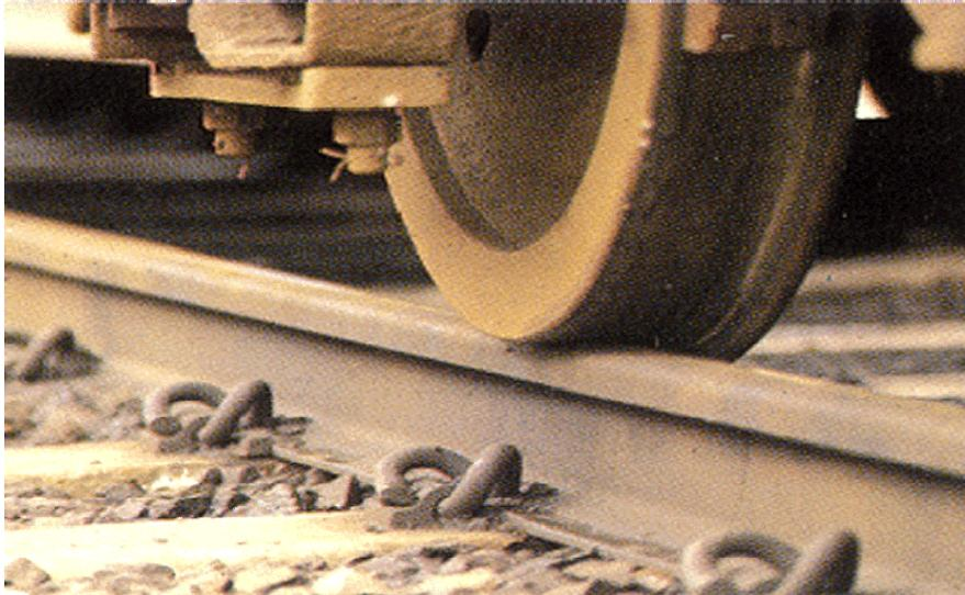
Fig. 33.- Grapa elástica Pandrol, en durmiente de concreto
