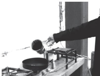
Vaciado del cemento asfáltico
