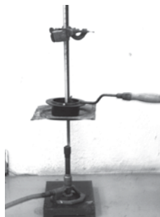
Montaje del equipo; ejes alineados verticalmente
