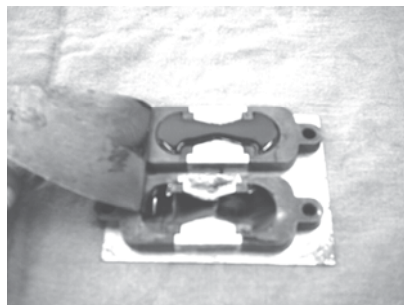
Retirando el exceso de asfalto con una espátula
