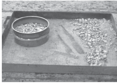
Cribado del material por la malla No. 12
