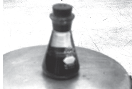
Peso del picnómetro con cemento asfáltico y agua destilada
