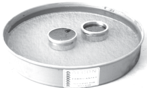
Baño maría para las pruebas de penetración y recuperación elástica por torsión
