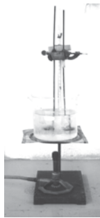
Muestras contenidas en agua a temperatura inicial de 5° C sobre la fuente de calor
