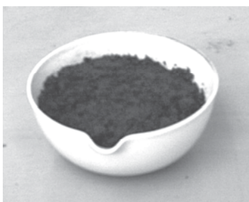
Material saturado en reposo durante 24hrs
