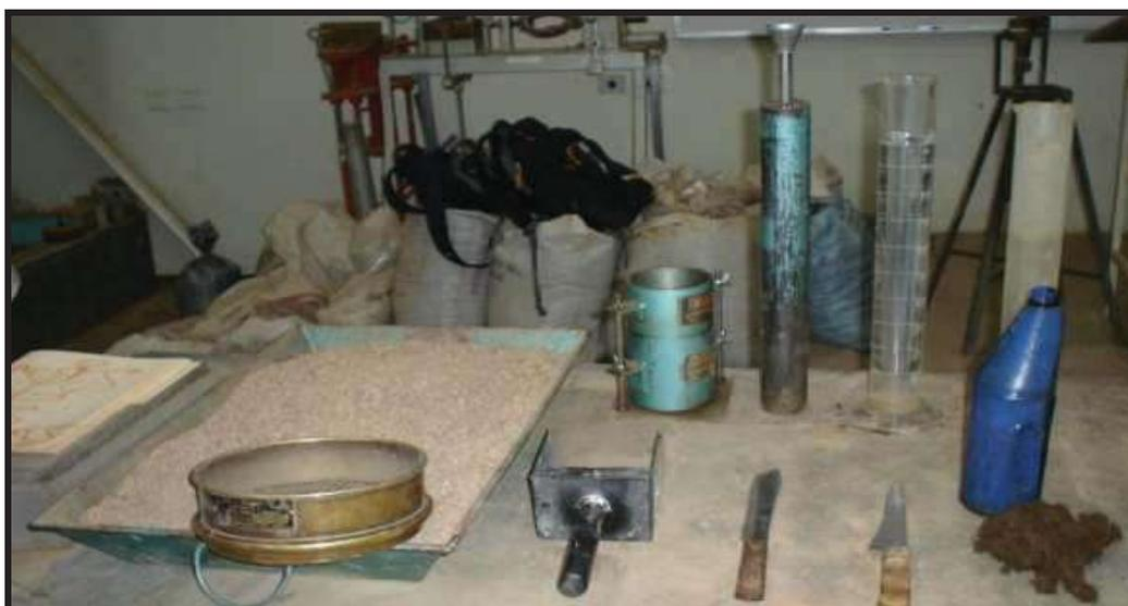
***Equipo necesario , para la realización de la prueba proctor estándar , las reglas metálicas pueden ser sustituidas por cuchillos de hoja larga y delgada.***
