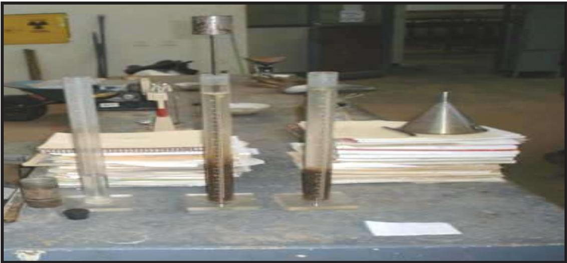
*Determinación del equivalente de arena, mediante las tres probetas, se puede utilizar un agitador mecánico.*
