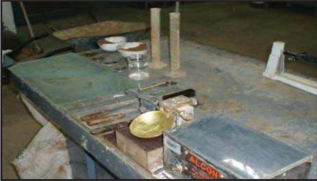
*Instrumental empleado, para la determinación del limite liquido, índice plástico y de la humedad natural.*
