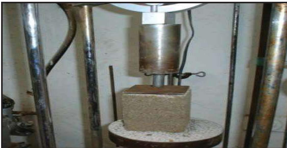
*Carga aplicada a un espécimen, para la determinación de su valor cementante.*
