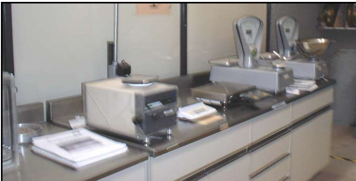
Foto 13.- Instrumental necesario para la determinación de la humedad natural .véase las balanzas de muy alta precisión y calidad.
