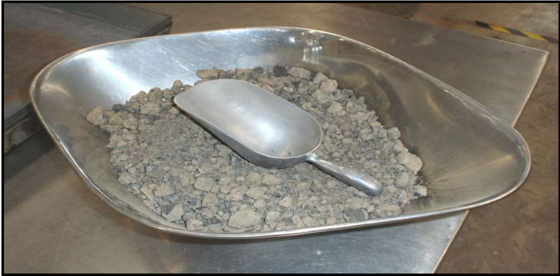
Foto 15.- Antes de realizar la granulometría chica el material se pesa en "seco" para posteriormente ser saturado.
