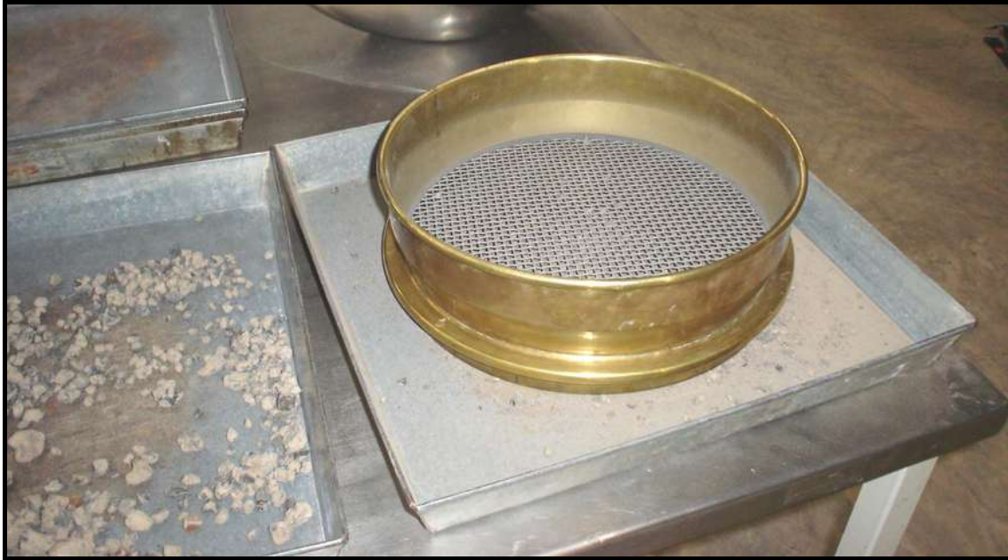
Foto 14.- Juego de mallas para la determinación de las granulometrías.
