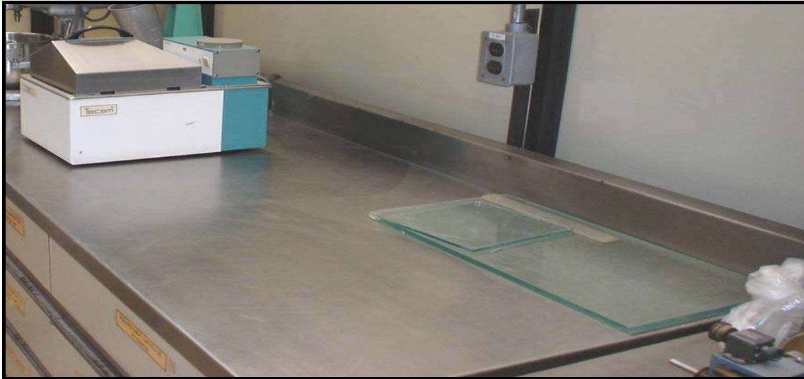
Foto 17.- Vidrios pulidos para determinar el límite plástico de los suelos cohesivos.
