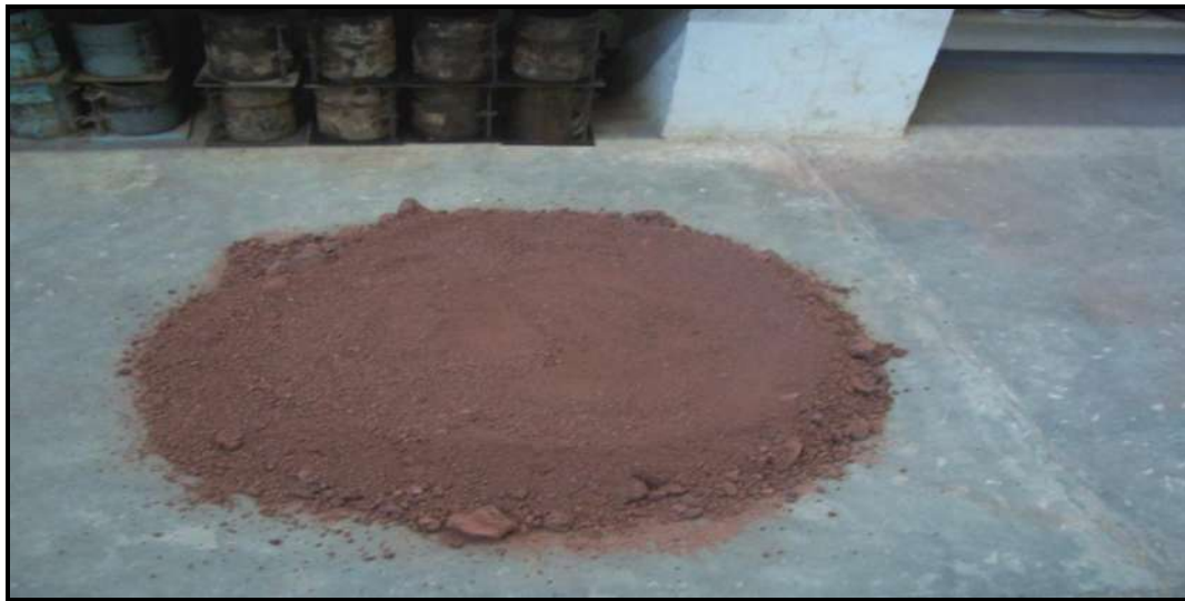
FOTO 2.- CONO TRUNCADO PARA POSTERIORMENTE SEPARARLO EN CUADRANTES.
