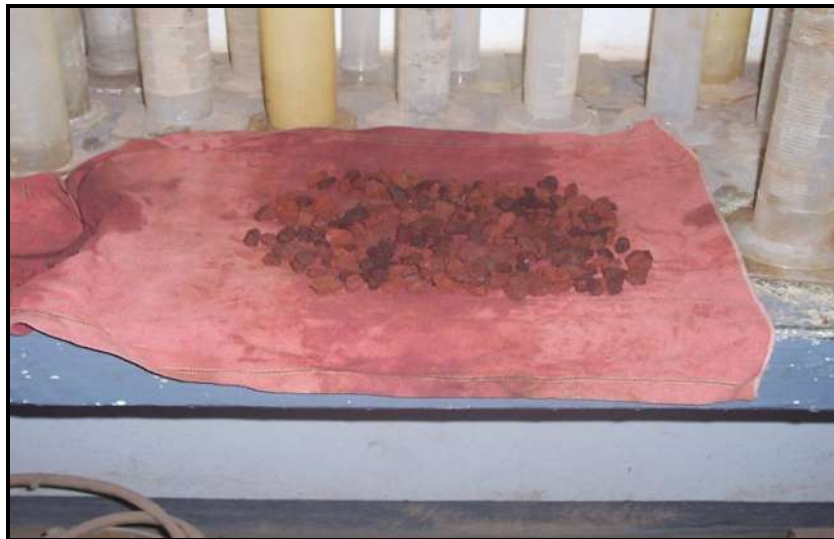
FOTO 6.- SECADO SUPERFICIAL DEL ESPÉCIMEN.
