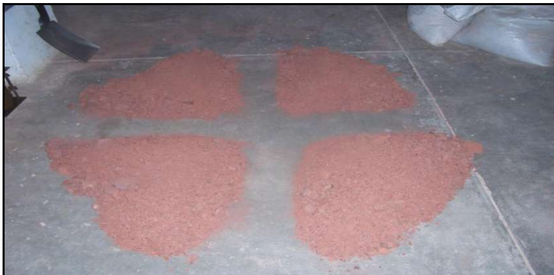
FOTO 3.- SE ELIMINAN DOS OPUESTOS Y SE TRABAJA CON LOS OTROS.
