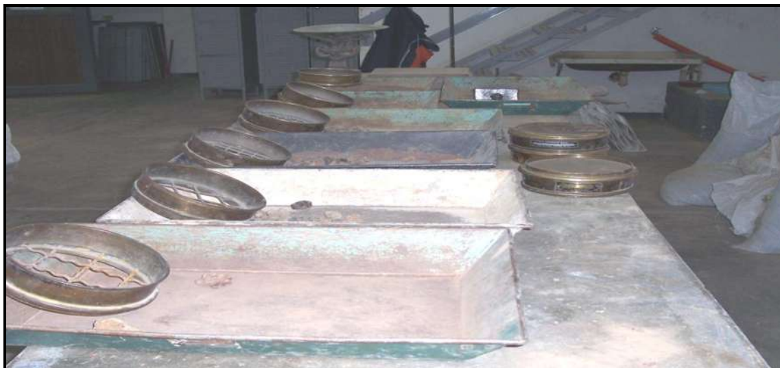
FOTO 4.- JUEGO DE MALLAS PARA REALIZAR LA GRANULOMETRÍA.
