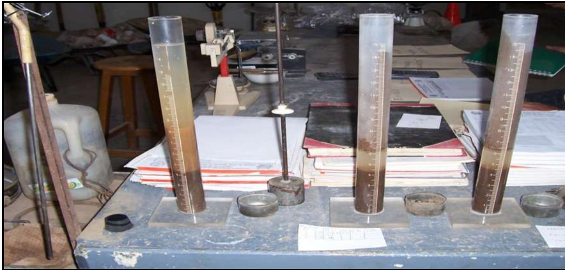
FOTO 8.- MUESTRAS DEL EQUIVALENTE DE ARENA.
