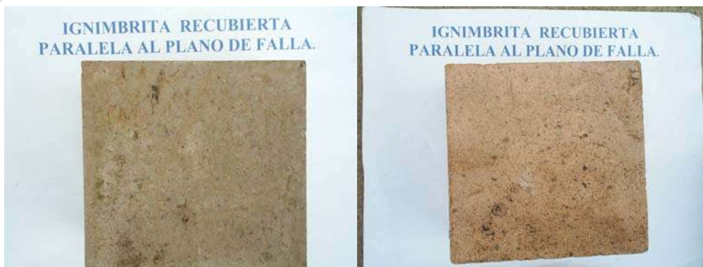
Fig. 45 Prueba De Intemperismo Natural Después Recubierta J.F. Gómez-Lara et. al 2006
