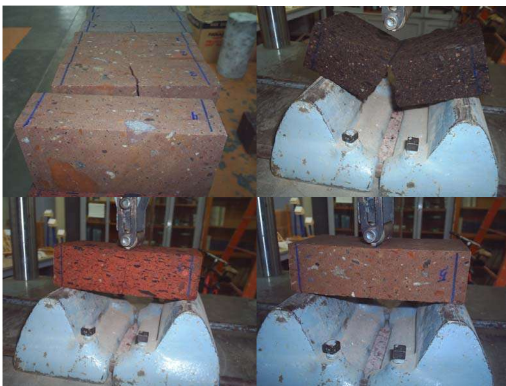
Fig. 30 Prueba de Modulo de Ruptura Perpendicular en Saturado J.F. Gómez-Lara et. al 2006.
