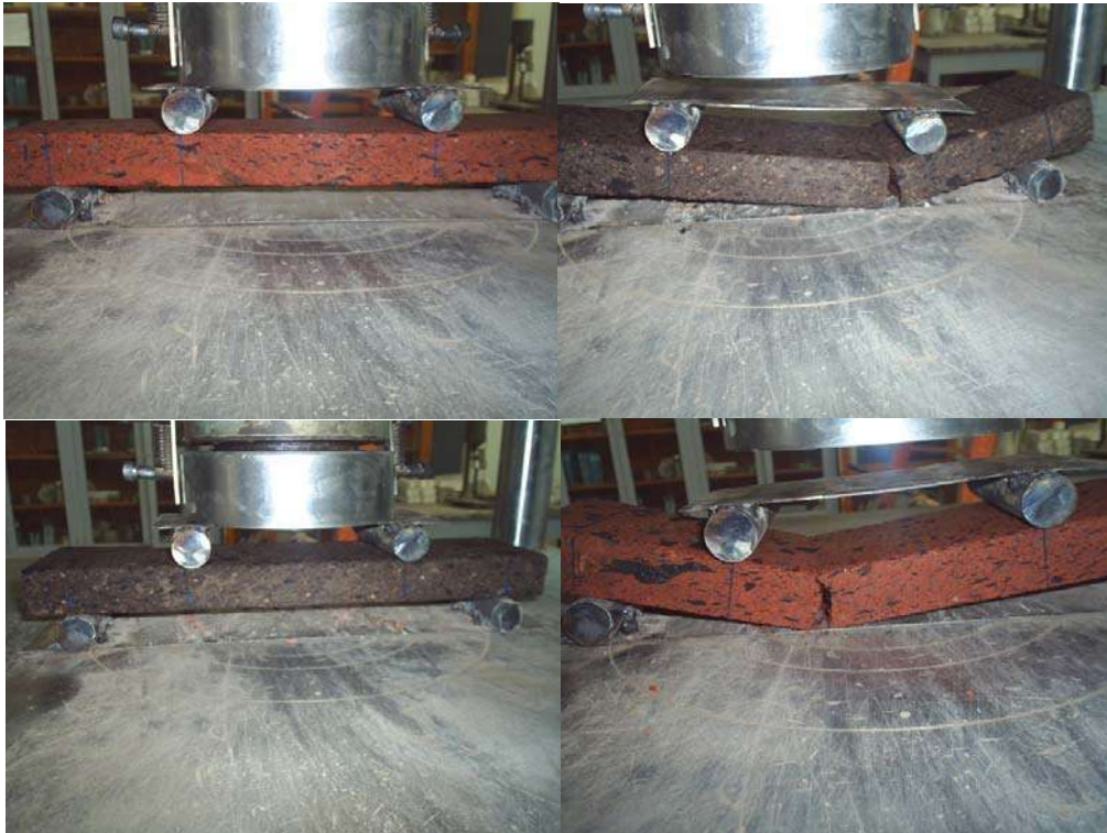
Fig. 26 Prueba de Flexión Perpendicular Saturado J.F. Gómez-Lara et. al 2006
