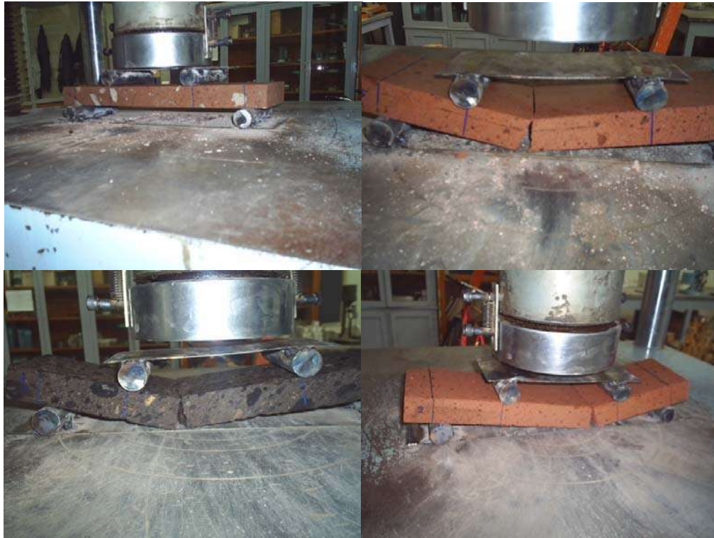
Fig. 25 Prueba de Flexión Paralela Saturada J.F. Gómez-Lara et. al 2006
