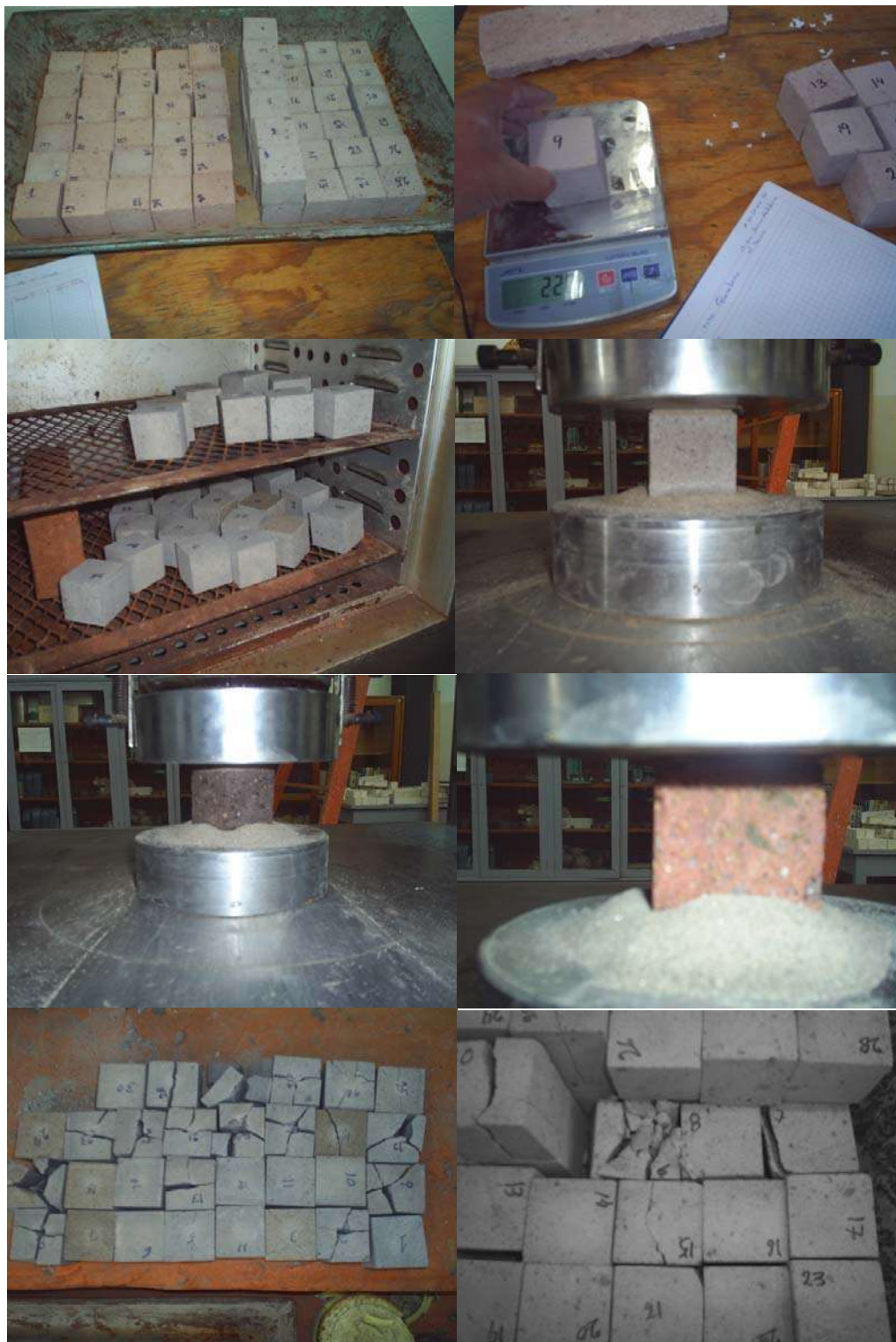
Fig. 21 Prueba de Compresión Simple Paralela J.F. Gómez-Lara et. al 2006
