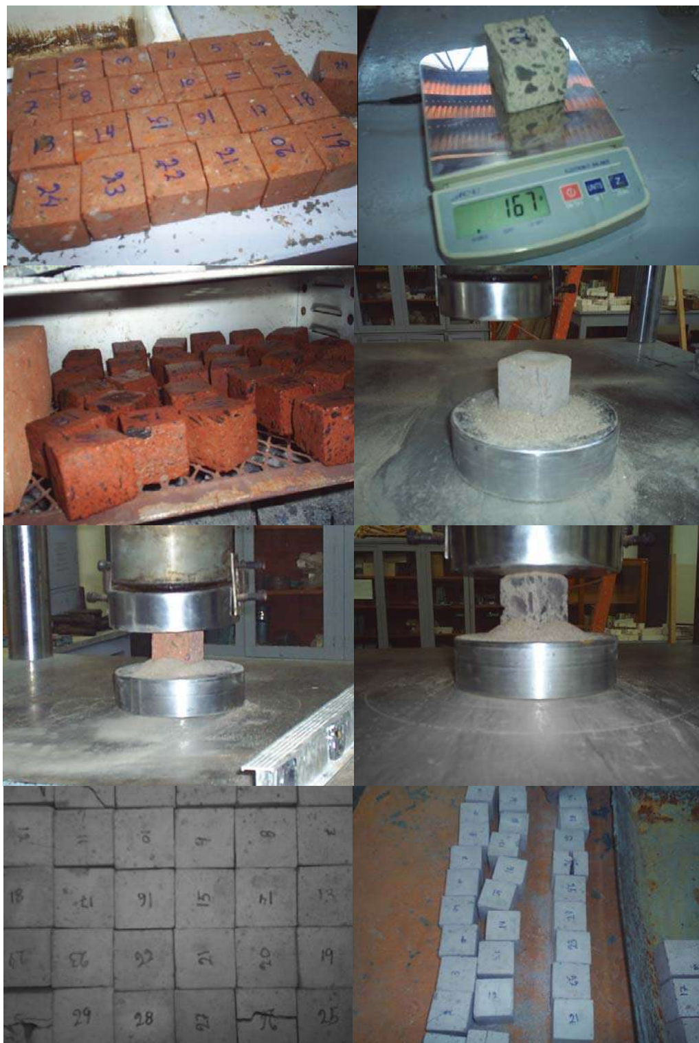
Fig. 22 Prueba de Compresión Simple Perpendicular J.F. Gómez-Lara et. al 2006
