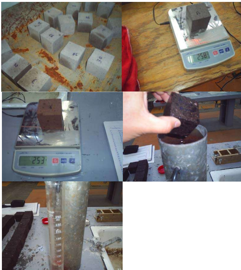
Fig. 19 Prueba de Densidad Con Picnómetro J.F. Gómez-Lara et. al 2006
