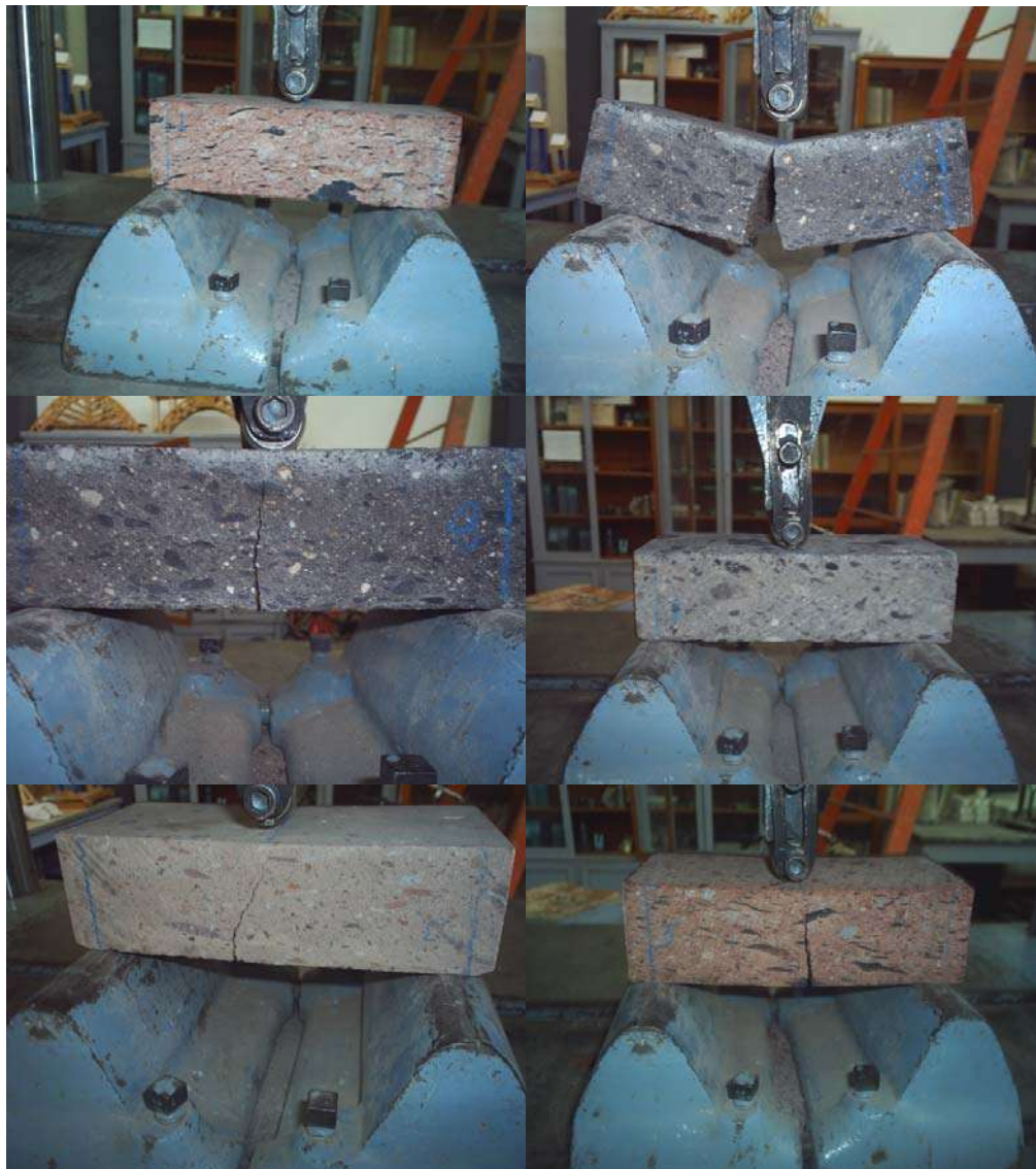
Fig. 28 Prueba de Modulo de Ruptura perpendicular en Seco J.F. Gómez-Lara et. al 2006
