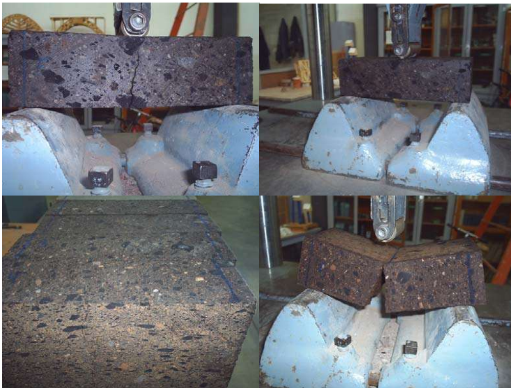
Fig. 29 Prueba de Modulo de Ruptura paralela en Saturado J.F. Gómez-Lara et. al 2006
