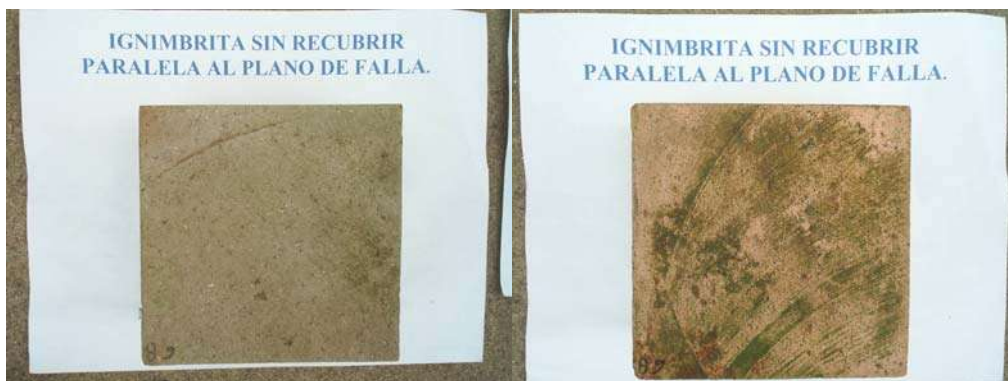
Fig. 46 Prueba De Intemperismo Natural Después sin Recubrimiento J.F. Gómez-Lara et. al 2006
