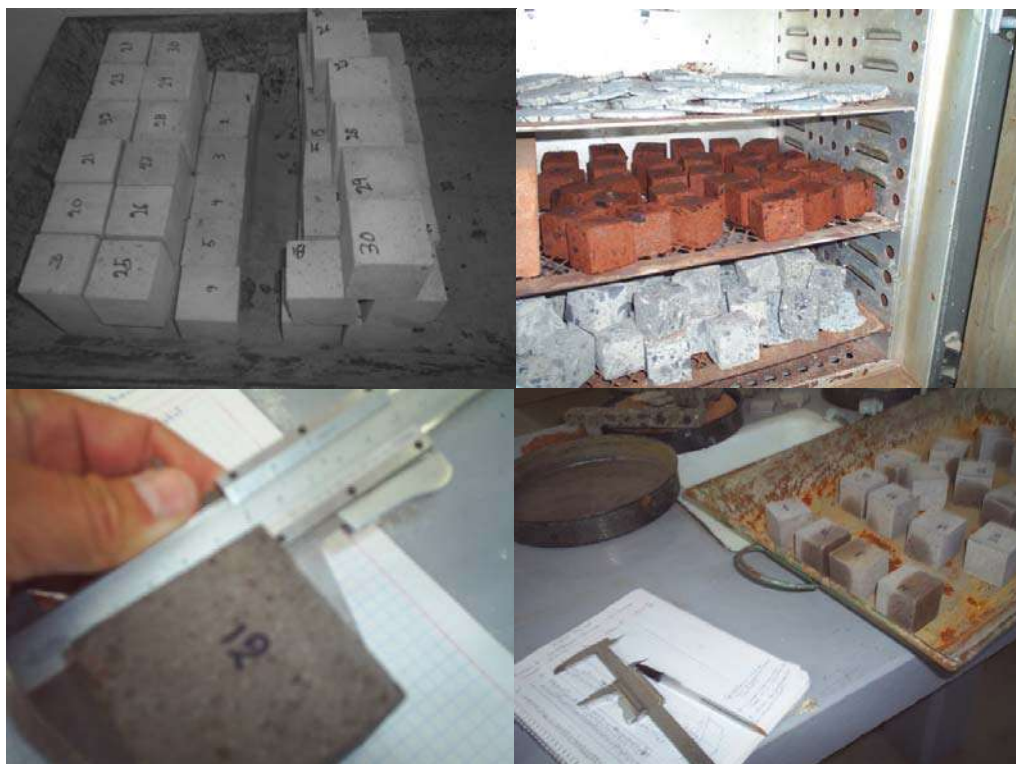
Fig. 20 Prueba de Densidad Con Medidas de Vernier J.F. Gómez-Lara et. al 2006
