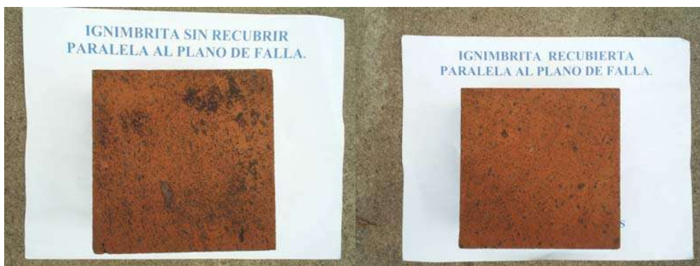
Fig. 47 Prueba De Intemperismo Natural Después Comparando las con y sin recubrimiento J.F. Gómez-Lara et. al 200
