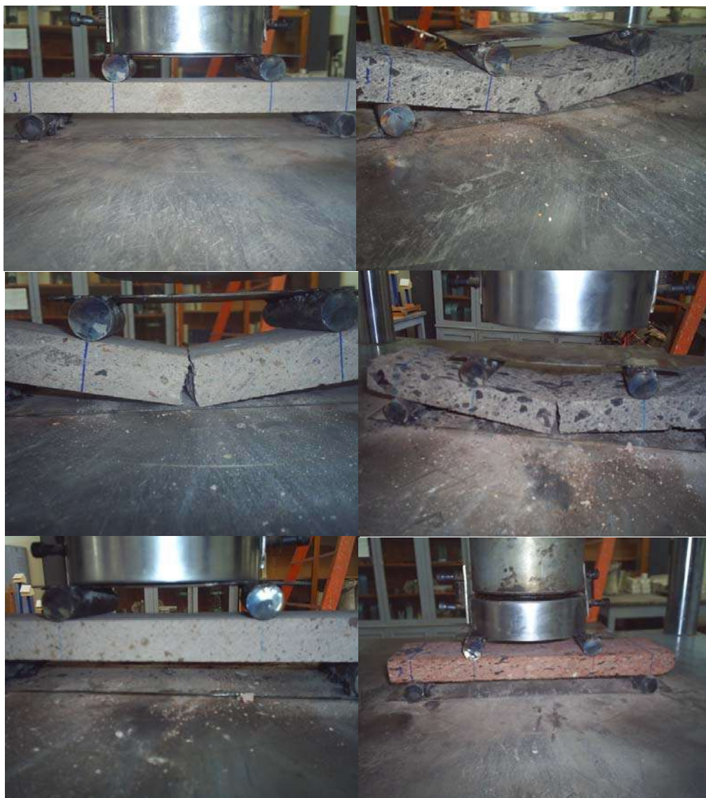
Fig. 24 Prueba de Flexión Perpendicular en Seco J.F. Gómez-Lara et. al 2006
