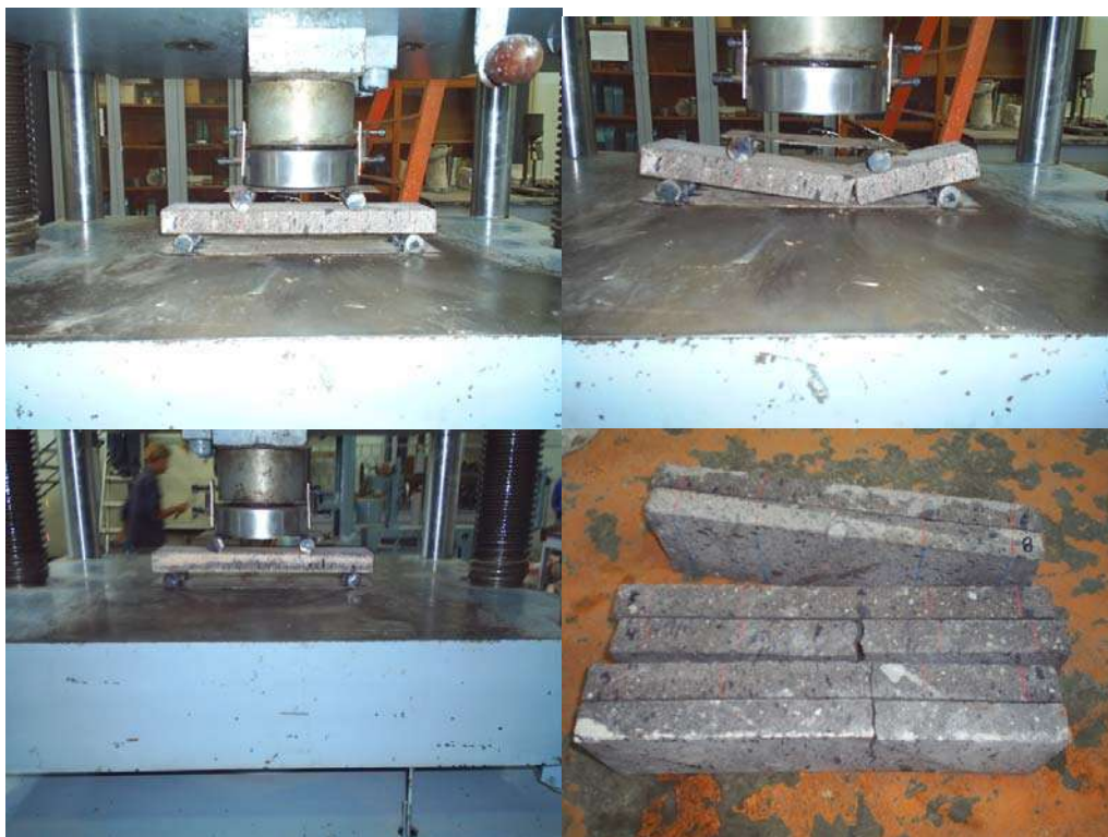
Fig. 23 Prueba de Flexión Paralela en Seco J.F. Gómez-Lara et. al 2006
