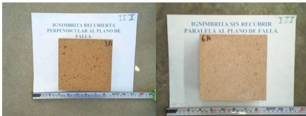
Fig. 40 Prueba De Sulfato de Sodio Antes J.F. Gómez-Lara et. al 2006
