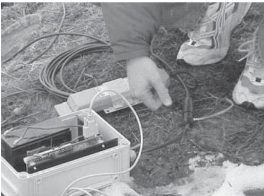
Fig. 4.a Instalación en campo del medidor Starflow
