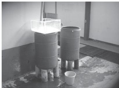
Foto. 6b. Tanque volumétrico de 200 litros
