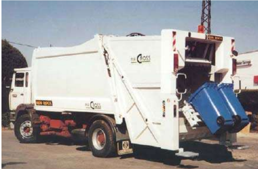
FOTO 3.16.- Vehículo compactador de carga lateral y trasera (FUENTE: CURSO TALLER SOBRE MEDIO AMBIENTE EN LA FACULTAD DE ING. CIVIL DE LA UMNSH)
