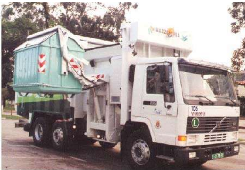
FOTO 3.15.- Vehículo compactador con carga lateral: (CURSO TALLER SOBRE MEDIO AMBIENTE EN LA FACULTAD DE ING. CIVIL DE LA UMNSH)
