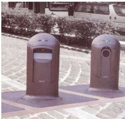
FOTO 3.6 Contenedor enterrados (Fuente: CURSO TALLER SOBRE MEDIO AMBIENTE EN LA FACULTAD DE ING. CIVIL DE LA UMNSH)
