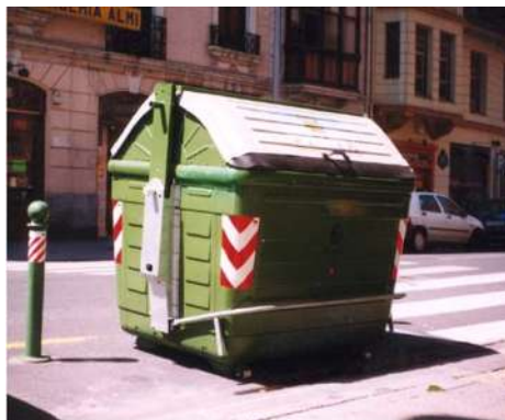
FOTO 3.5 Contenedor de 4 ruedas de 3.2 \text{ m}^3 (Fuente: CURSO TALLER SOBRE MEDIOAMBIENTE EN LA FACULTAD DE ING. CIVIL DE LA UMNSH)
