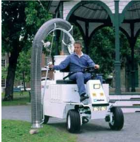
FOTO 3.10.-Aspiradora para exterior con tracción en todas las ruedas (FUENTE: MAVDAC)
