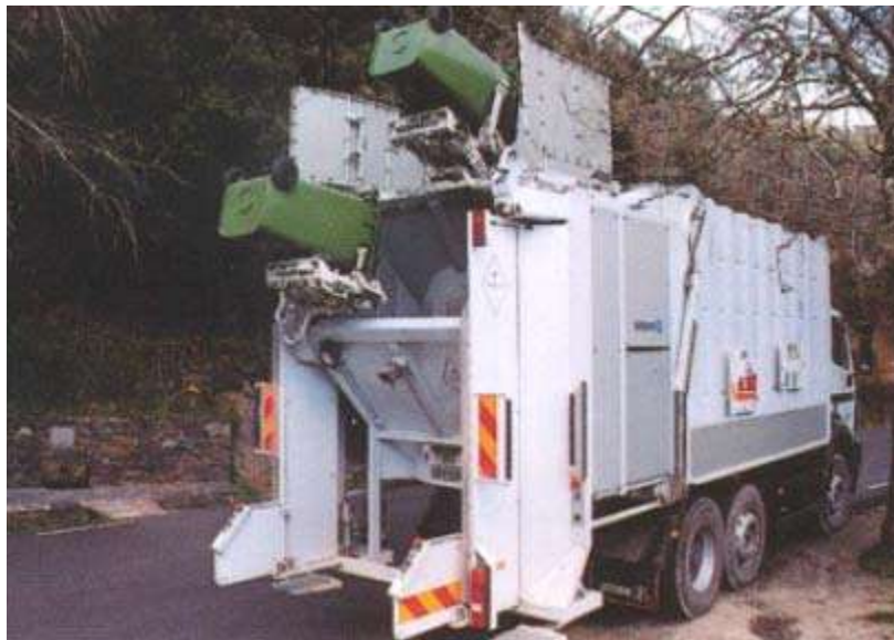
FOTO 3.17.- Vehículo compactador de carga lateral y trasera. (FUENTE: CURSO TALLER SOBRE MEDIO AMBIENTE EN LA FACULTAD DE ING. CIVIL DE LA UMNSH)
