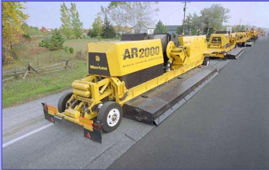
Tren de reciclado en caliente in situ (Fuente: Martec Recycling Corporation <[www.martec.ca](http://www.martec.ca)>)
