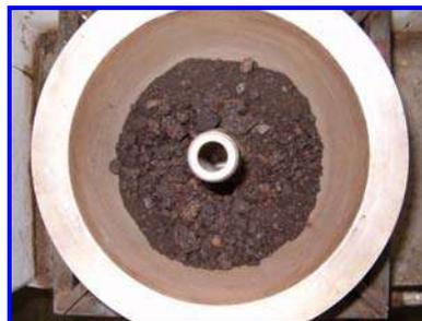
Muestra sin Cemento Asfáltico.
