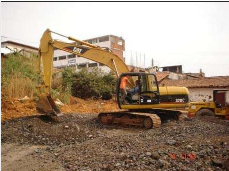
La excavadora cuenta con un motor a diesel con un tanque de combustible de 400 L, tiene una potencia neta en el volante de 138 hp, tiene un peso de 21,000 Kg., su máxima velocidad de desplazamiento es de 5.5 Km. por hora y su ancho para su transporte es de 3.18 m.
