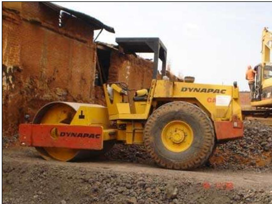
El rodillo cuenta con un motor marca Cummins, el cual tiene una potencia de 2400 RPM, cuenta con un tanque de combustible de 266 L., tiene un peso de 10,000 kg. y una velocidad máxima de 8 Km./h. Al momento de realizar la compactación cuenta con una carga de 25.1 Kg./cm.
