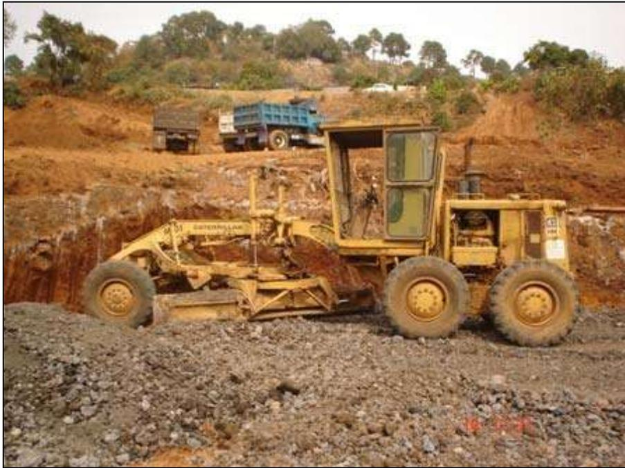
El peso del vehículo es de 14661 kg., la hoja tiene un ancho de 4.26 m. y un espesor de 2.2 cm., la velocidad máxima hacia delante es de 41.1 kph y en retroceso es de 32.4 kph, cuenta con un tanque de combustible de 284 L., cuenta con un sistema neumático doble que brinda una capacidad de frenado a cada lado de la máquina.
