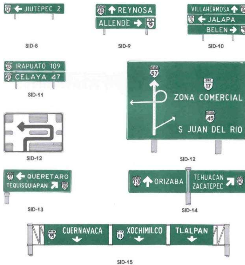
Figura 6.12 Señales Informativas de destino
