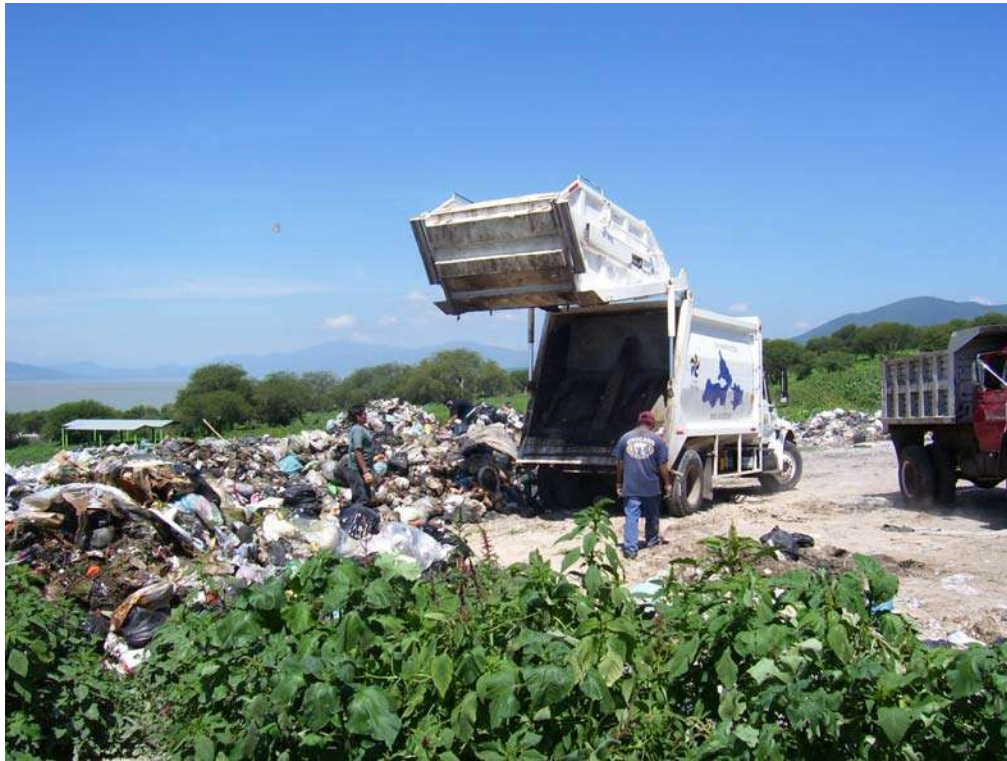
VACIADO DE RESIDUOS DEL CAMIÓN COMPACTADOR
